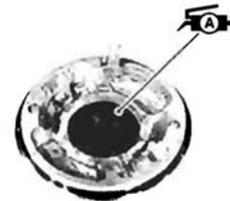
• Aplique un poco de MOLY PASTE al extremo del eje del rotor.
