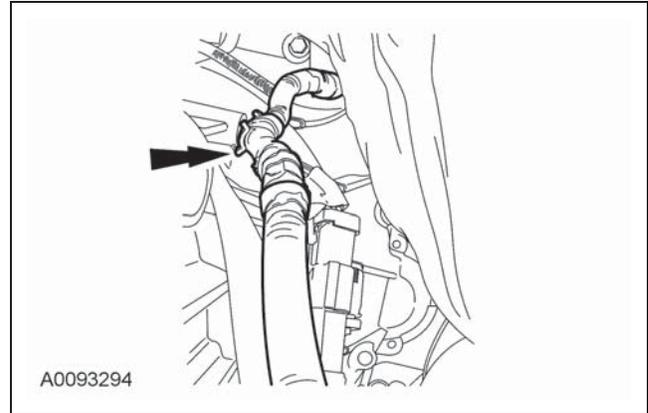
9. Instale el conector eléctrico del sensor de monitoreo del catalizador (CMS) al lado izquierdo de la transmisión.
