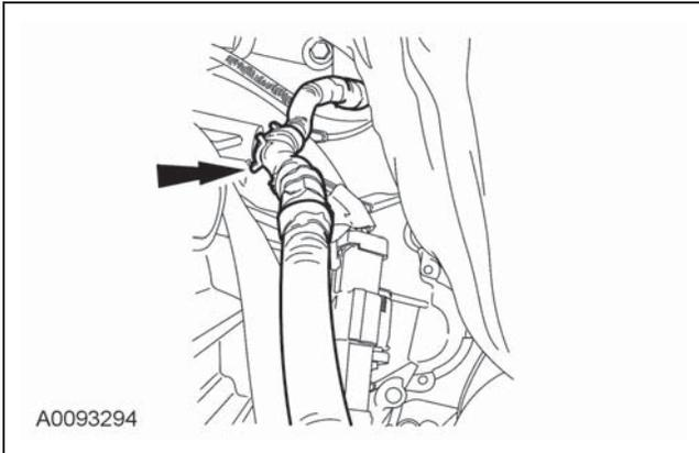
23. **⚠ PRECAUCIÓN: No jale el arnés de cableado para desconectar el conector o se puede originar un daño en el conector.**
