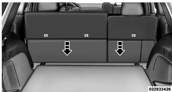
Desmontaje del tablero del piso alfombrado para tener acceso a la correa superior
