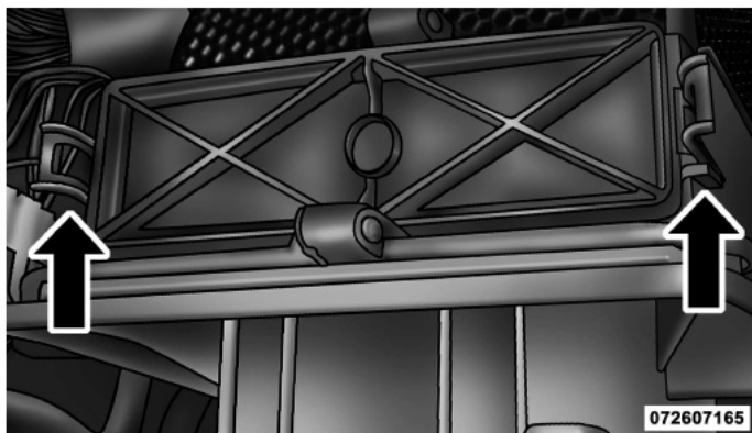
Reemplazo del filtro de aire del aire acondicionado
