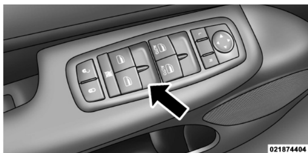
Interruptores de las ventanas eléctricas
