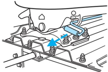
6. Trabe la palanca y retire el camión.
