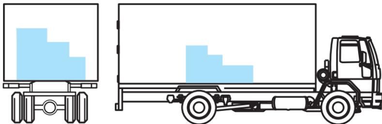
La distribución correcta de la carga sobre los ejes está establecida cuando el centro de gravedad de la carga se ubica un poco por delante del eje trasero.
