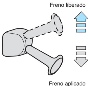
No se debe intentar poner el vehículo en movimiento hasta que la presión de aire del sistema llegue a 6,7 x 100 kPa (6,8 bar), pues las ruedas traseras estarán trabadas por la acción del freno del resorte. Por debajo de ésta presión el freno de estacionamiento permanece “aplicado”.
