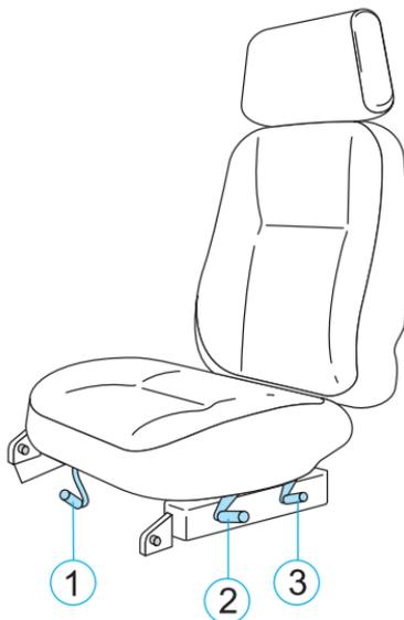
El sistema de regulación del asiento permite mover independientemente la parte delantera y trasera del mismo.
