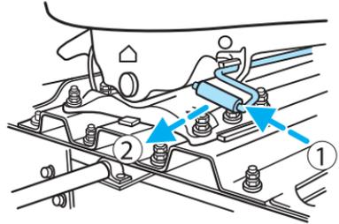
5. Acople los conectores neumáticos y la toma eléctrica.
