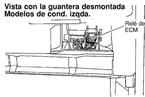
3. Compruebe la continuidad del arnés entre la terminal 7 del relevador del ECM y la terminal 1 del condensador. Consulte el diagrama eléctrico.
