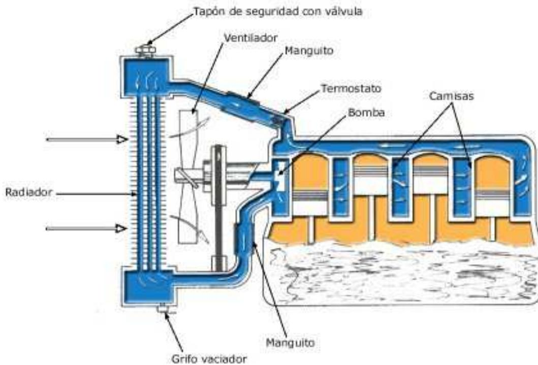
Una polea accionada accionada por el cigüeñal hace funcionar el ventilador que lleva a pasar el aire por el radiador.
