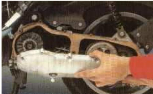
Ya tenéis todo a mano. Ahora debéis quitar la tuerca que fija el variador al eje del cigüeñal. Como éste gira, hay que inmovilizarlo con una herramienta especial ( llamada estrangulador ), que si no disponéis de ella, podéis reemplazar con un destornillador, mordaza...
