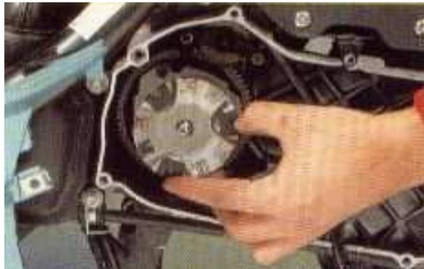
En el montaje engrasad ligeramente los rodillos, y situadlos en la posición correcta en el cuerpo del variador.
