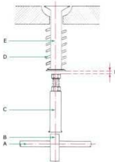
En un motor caliente, si se observa que las válvulas no cierran herméticamente, será debido, generalmente, a que los taqués están mal reglados.
