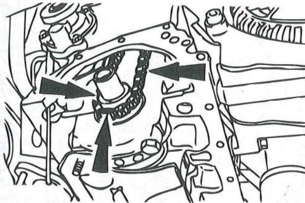
**Nota:** La marca de sincronización del engrane del cigüeñal y el único eslabón coloreado en la cadena de sincronización deben estar alineados. La marca de sincronización del engrane del cigüeñal debe estar en la posición de las 6 horas.
