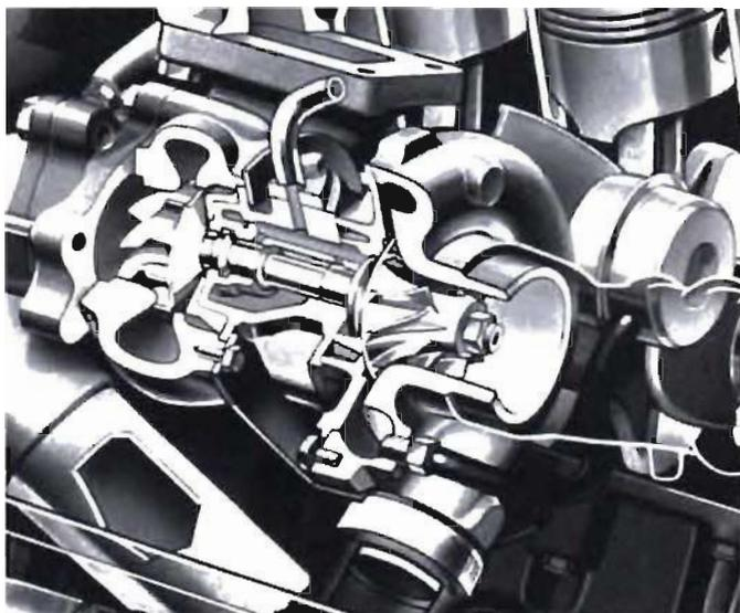
**Figura 8.** Corte turboalimentador.
