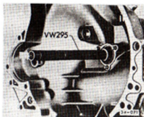
Figura 11 Instalar el deflector de aceite del árbol de mando.
