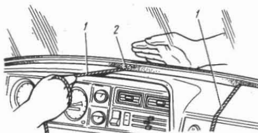
Fig. 8-15. Instalación del parabrisas; 1 - cordón para instalar el cristal; 2 - empaquetadura
