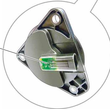
O sensor Hall da caixa de transferência G759 está rosqueado na carcaça traseira da caixa de transferência. Uma montagem incorreta do sensor Hall não é possível em razão dos três parafusos de fixação dispostos assimetricamente, uma aba de codificação e a posição assimétrica da lingueta de acionamento.
