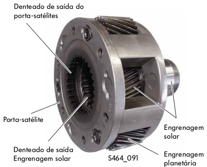
**Conjunto simples de engrenagens planetárias (estrutura esquemática)**
