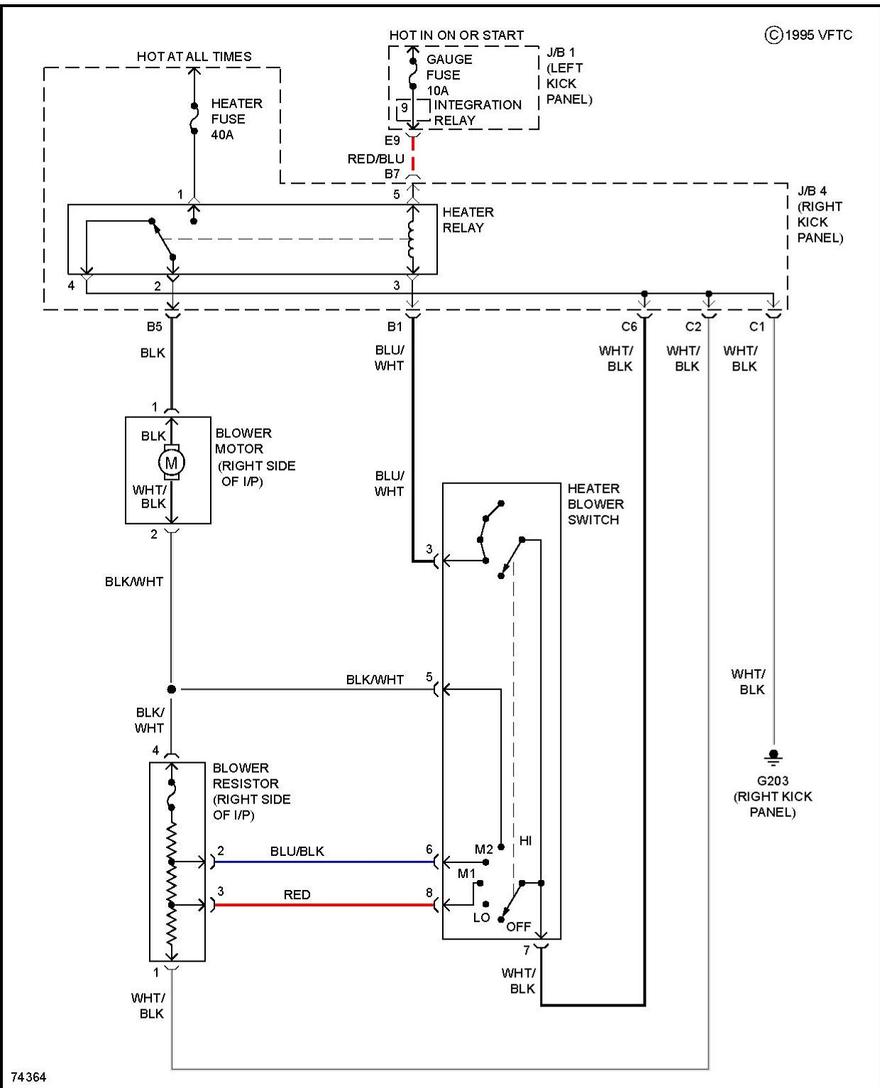
**Fig. 2: Heater Circuit**
