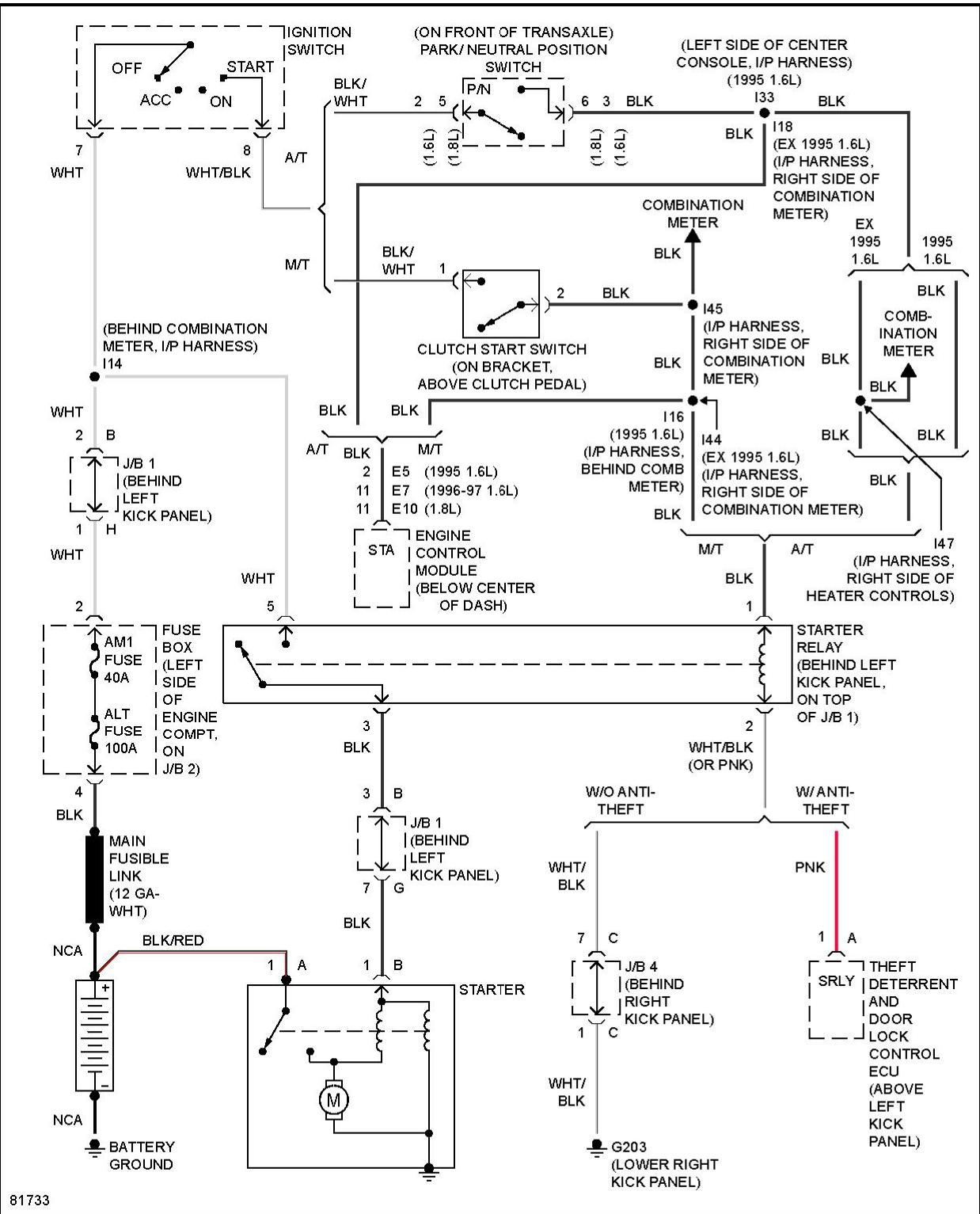
**Fig. 38: Starting Circuit**
