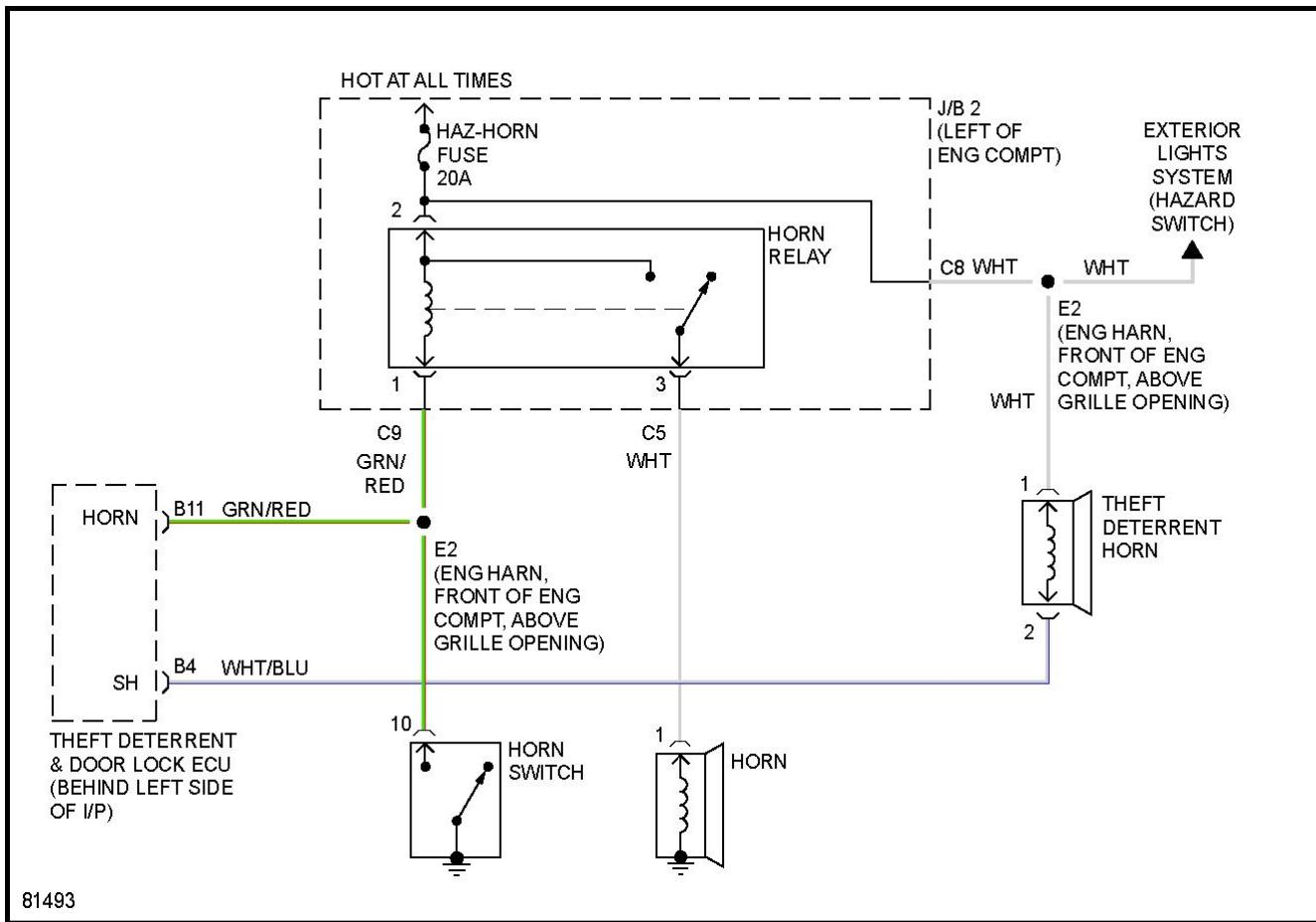
**Fig. 21: Horn Circuit**
