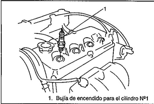
1. Bujía de encendido para el cilindro N°1
