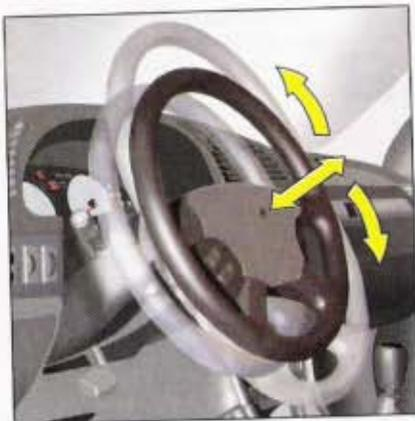
El volante puede ser regulado en altura y en profundidad.
