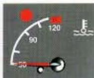
**Indicador de temperatura del líquido de refrigeración motor**
