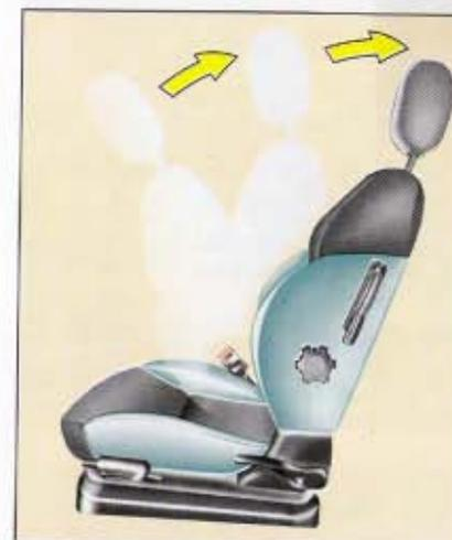
Para colocar de nuevo el asiento en su posición normal, levantar el respaldo hacia atrás hasta su bloqueo; el conjunto recupera su posición inicial.
