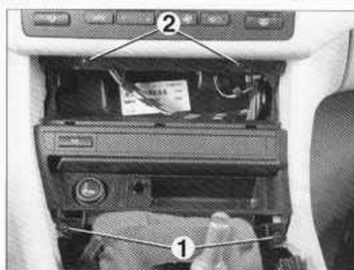
Desmontaje del conjunto cenicero-bandeja. 1. Tornillo de cenicero - 2. Tornillo de bandeja.
