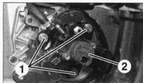
Bomba de alta presión. 1. Tuercas de fijación - 2. Regulador de alta presión.
