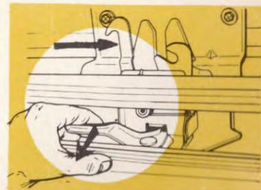
El capó tiene un sistema de bisagras balanceado, lo cual le permitirá abrirlo con un mínimo de esfuerzo.
