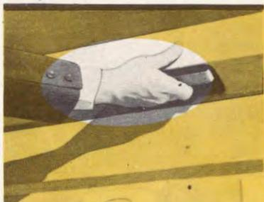
Apoye una mano sobre el borde exterior acompañando el movimiento de descenso de la puerta. Esta finalmente quedará horizontal, sostenida en tal posición por los tensores articulados laterales. Como la tapa quedará a nivel del piso de la caja se facilitará el deslizamiento de los bultos hacia el interior.
