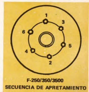
Antes de la instalación debe asegurarse que las roscas de los bulones y de las tuercas estén limpias y sin materias extrañas. Las roscas deberán lubricarse con aceite de motor.
