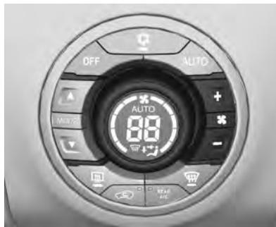
Presione el botón + o el botón - para aumentar o disminuir la velocidad del ventilador. La velocidad seleccionada del ventilador se indica por medio de las barras en la pantalla.
