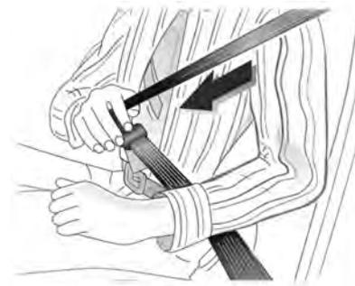
Extraiga el cinturón del carrete, guíelo sin retorcer de un extremo al otro del cuerpo y enganche la placa de seguro a la hebilla. Tense el cinturón de seguridad de dos puntos mientras conduce jalando del cinturón del hombro.
