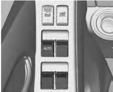
Opere el interruptor para cada ventana respectiva oprimiendo para abrir o jalando para cerrar. El interruptor para la ventana del conductor tiene una luz que indica, por medio de iluminación, que la operación está lista.
