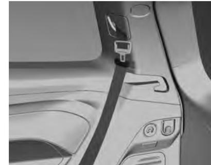
Antes de operar la cubierta del compartimiento de carga, guíe los cinturones de seguridad a través de los sujetadores de cinturón.
