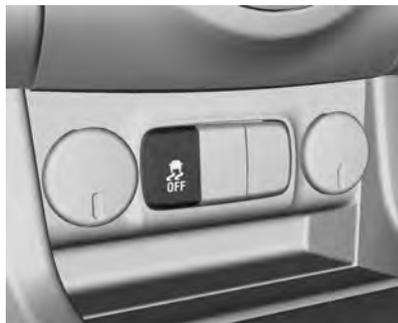
El Control de tracción se puede apagar cuando se requiere el deslizamiento de la rueda de tracción: presione el botón
