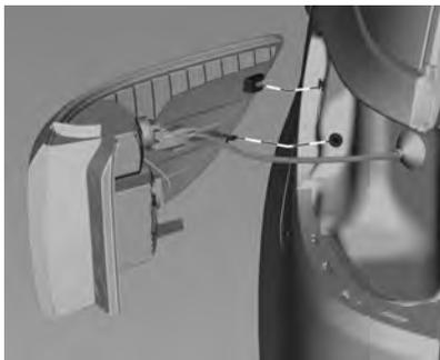
2. Retire el ensamble de la luz trasera jalándolo hacia fuera de la carrocería. Retire el conector eléctrico.
