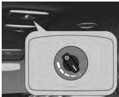
El ventilador de aire acondicionado trasero ayuda al flujo de aire al compartimiento trasero de pasajeros por medio de las ventilas traseras de aire.
