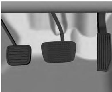
Para asegurar que no haya interferencia en el trayecto del pedal revise la instalación correcta de los tapetes de piso.
