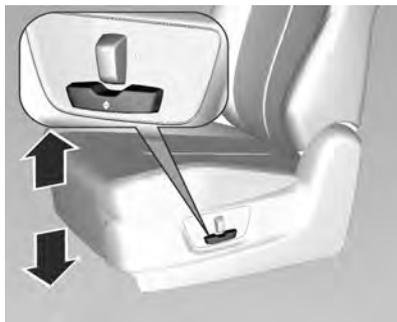
La altura se puede ajustar moviendo el interruptor hacia arriba o hacia abajo.
