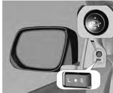
Los controles de los espejos eléctricos se encuentran en la moldura de la puerta junto al conductor.
