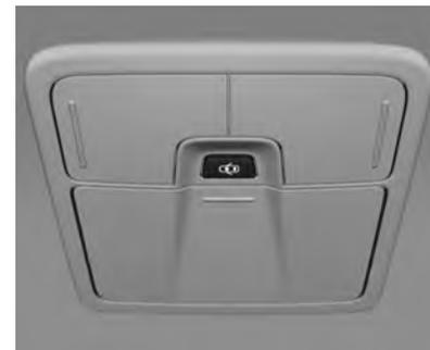
Cuando entre o salga del vehículo, las luces de cortesía se encienden automáticamente si se presiona el botón y después de una demora breve se vuelven a apagar. Se encienden por un tiempo corto, incluso si la llave se retira de la cerradura de ignición.
