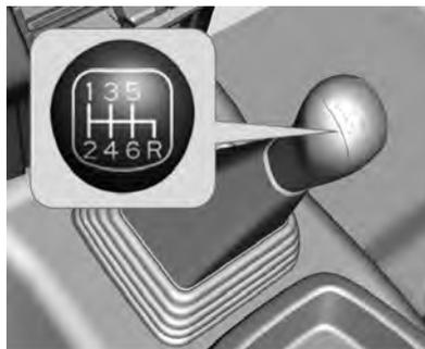
Reversa: con el vehículo detenido, presione el pedal del embrague y enganche la velocidad.
