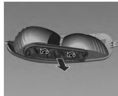
2. Desatornille ambos tornillos para retirar el soporte del foco.
