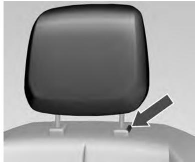
Para bajar, presione el botón y empuje el reposacabezas hacia abajo. Para ajuste de la altura, empuje el reposacabezas hacia arriba.
