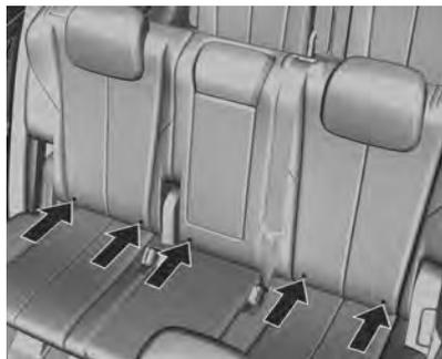
Asegure los sistemas de restricción para niños ISOFIX aprobados para el vehículo a los soportes de montaje ISOFIX. Las posiciones del
