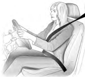
Los cinturones se bloquean durante una aceleración o desaceleración intensa del vehículo para seguridad de los ocupantes.
