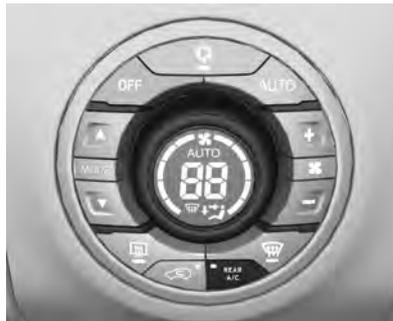
El sistema de aire acondicionado trasero se opera con el botón **REAR A/C**.
