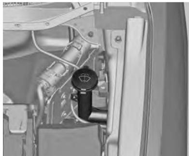
Llene con agua limpia mezclada con una cantidad adecuada de solución para lavado del parabrisas.
