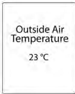
Una baja en la temperatura se indica inmediatamente y una elevación en la temperatura después de un retraso de tiempo.
