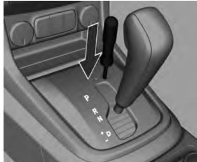
3. Inserte un desarmador en el orificio hasta que la palanca esté desbloqueada, mueva la palanca hacia afuera de la posición **P** y muévala a la posición **N**.
