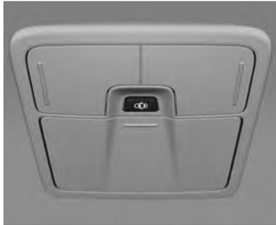
Cuando entre o salga del vehículo, las luces de cortesía se encienden automáticamente si se presiona el botón y después de una demora breve se apagan de nuevo. Se encienden durante un periodo breve si se retira la llave del seguro de la ignición.
