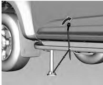
Si la llanta pinchada se encuentra en el frente del vehículo, coloque el gato detrás de la llanta delantera, en la muesca del bastidor.
