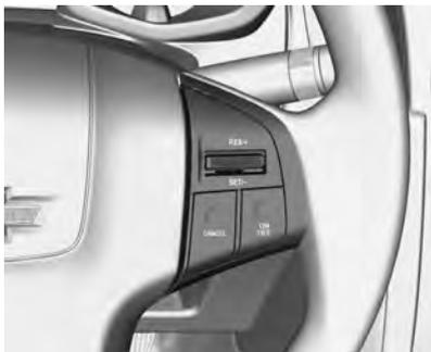
El sistema de control de velocidad de crucero se puede operar por medio de los controles del volante.
