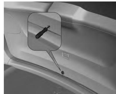
Para abrir la compuerta levadiza en el caso de interrupción de energía: retire la cubierta de la moldura interior del área del seguro central. Empuje una herramienta adecuada hacia adentro tanto como sea posible y gírela en sentido contrario a las manecillas del reloj para abrir la compuerta levadiza.
