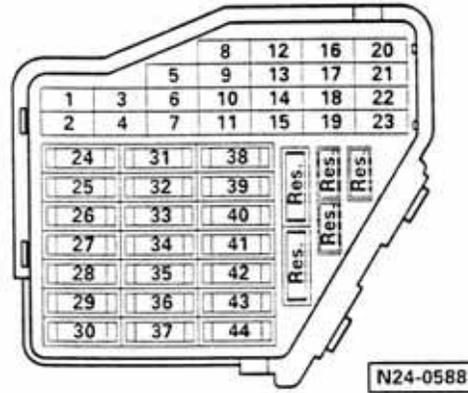
En los Esquemas de Circuitos los fusibles apartir del S23 se les adiciona un 2 al iniciar: por ejemplo S40 se llama S240
