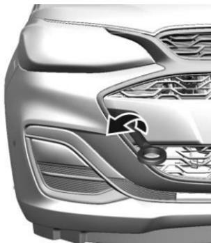
Atornille la argolla de remolque tanto como sea posible hasta que se detenga en una posición horizontal (debe estar en contacto con la tuerca de remolque).
