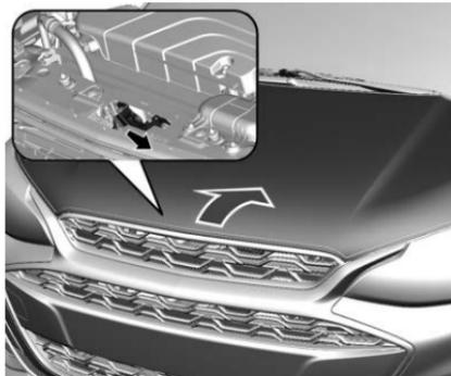
Vaya al frente del vehículo y mueva la palanca secundaria de liberación del cofre hacia el lado derecho del vehículo.
