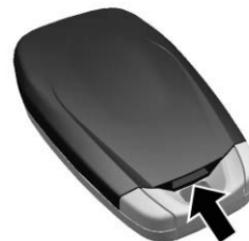
Extienda la llave y abra la unidad. Reemplace la batería (tipo de batería CR 2032), poniendo atención a la posición de la instalación. Cierre la unidad y sincronice.
