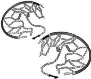
Sólo se permiten cadenas para llantas en las ruedas delanteras.
