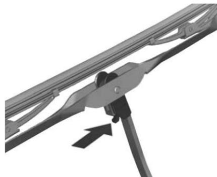
Levante el brazo del limpiador. Presione la palanca de liberación y desconecte el asa del limpiador.
