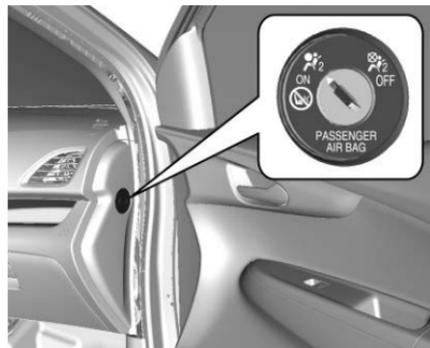
El sistema de bolsa de aire del pasajero delantero se puede desactivar mediante un interruptor operado con llave en el lado derecho del tablero de instrumentos.
