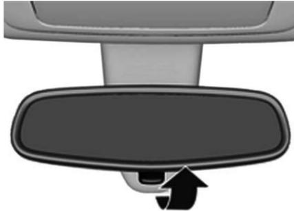
Para reducir el deslumbramiento, ajuste la palanca debajo de la carcasa del espejo.
