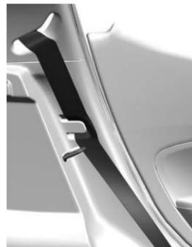
5. Coloque los cinturones de seguridad para los asientos exteriores en las guías para el cinturón.
