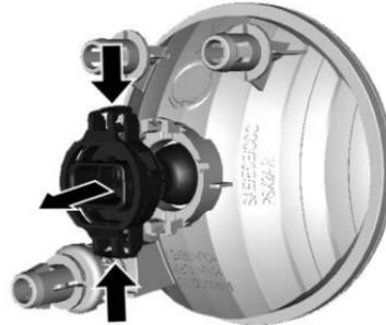
2. Desconecte el conector eléctrico del soporte del foco.
