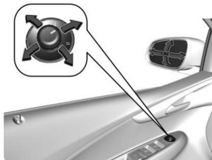
Seleccione el espejo exterior relevante girando el control hacia la izquierda (L) o derecha (R). Luego mueva el control para ajustar el espejo.
