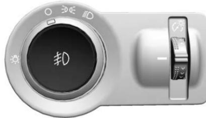
Presione para encender o apagar los faros de niebla delanteras. Cuando las luces anti-niebla se encuentran encendidas se enciende un indicador en el grupo de instrumentos.
