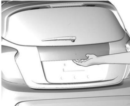
Para abrir la puerta trasera, con todas las puertas desbloqueadas, oprima el interruptor de teclado táctil en el lado inferior de la manija de la puerta trasera y levante.
