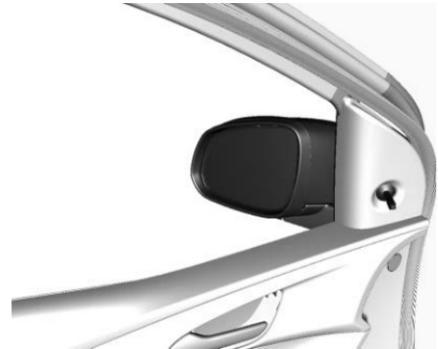
Si está equipado, mueva el control hacia arriba, abajo o los lados para ajustar el espejo.
