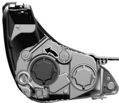
1. Retire la cubierta del foco del faro girándola en sentido contrario a las manecillas del reloj.
