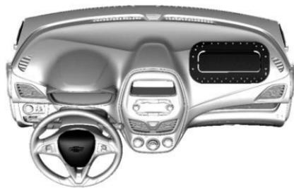
El sistema de bolsa de aire delantera se acciona en caso de un impacto de extremo delantero de cierta gravedad. La ignición debe estar encendida.
