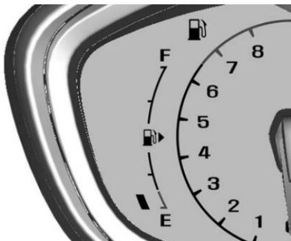
El indicador de control
