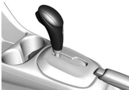
**P** : (estacionamiento) En la posición de estacionamiento, las ruedas delanteras están bloqueadas. Seleccione P únicamente cuando el vehículo esté detenido y el freno de estacionamiento esté aplicado.
