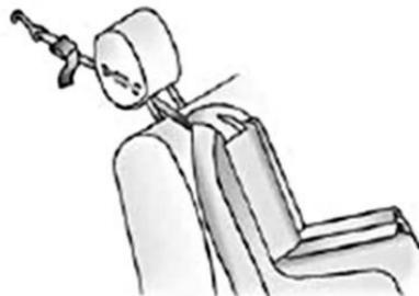
Si la posición de asiento exterior trasero que está utilizando tiene una cabecera ajustable y está utilizando sólo una atadura, levante la cabecera y pase la correa por debajo de la cabecera así como entre las barras de la cabecera.
