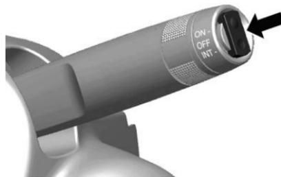
Presione el interruptor del oscilador para activar el limpiaparabrisas trasero:
