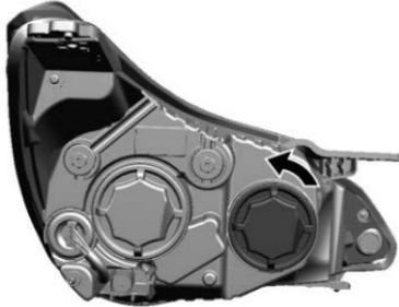
1. Retire la cubierta del foco del faro girándola en sentido contrario a las manecillas del reloj.
