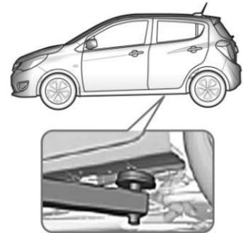
Posición del brazo trasero de la plataforma de levantamiento ubicada en la posición central del silo.
