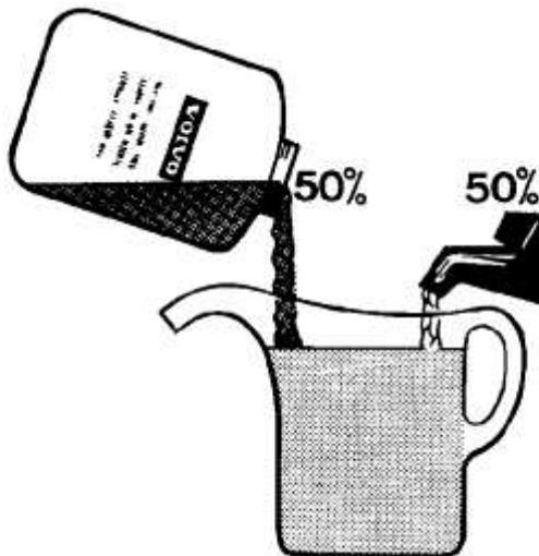
Llene el sistema de refrigeración por el depósito de expansión. La capacidad total de refrigerante es de aproximadamente **7,2 litros**. Ponga en marcha el motor hasta que alcance temperatura de funcionamiento y rellene de refrigerante si es necesario. Compruebe si hay fugas.
