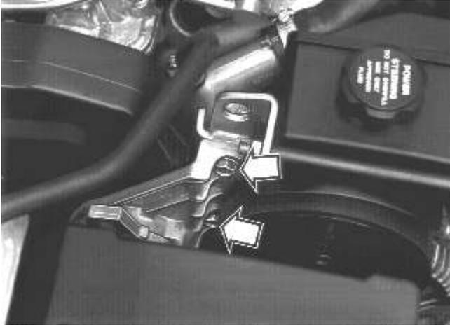
Afloje los dos tornillos del tensor de la correa y quite el tensor.
