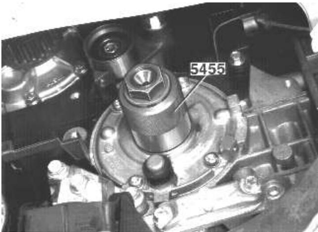
Quite la junta usada. Utilice un cincel de corte de ranuras. Limpie la superficie de contacto.
