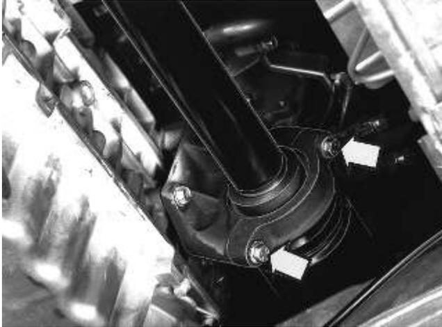
**¡Atención! Tenga cuidado de no dañar el aro retén de la transmisión ni la funda del eje de tracción.**
