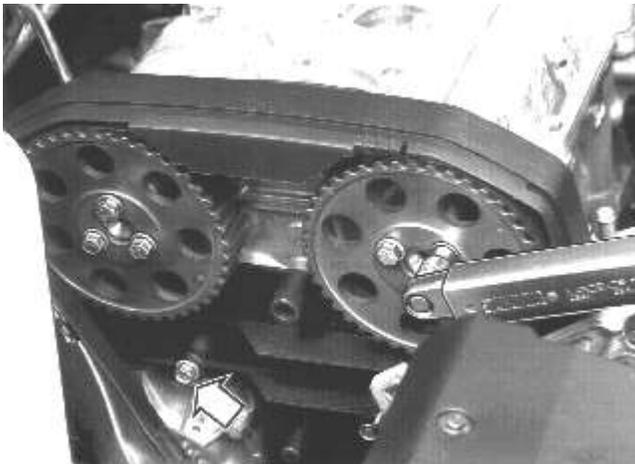
Coloque el tercer tornillo y apriete los tornillos a **20 Nm**.
