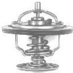
El termostato puede comprobarse en agua caliente. La abertura máxima deberá tener lugar en **2 minutos** en agua a la temperatura de apertura.
