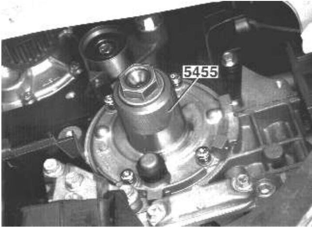
Utilice una **junta** nueva. Utilice la herramienta [999 5455](#) cuando instale la bomba. Utilice los tornillos como guías.
