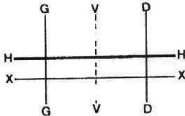
Fig. P-10 Tablero control para la regulación de faros
