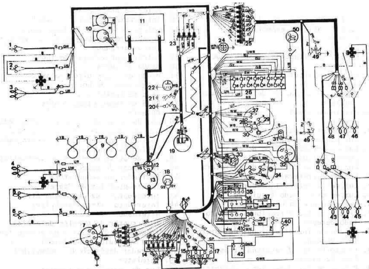
Fig. P-3 Esquema eléctrico Land-Rover 2,25 litros Diesel (88" Ligero Civil)
