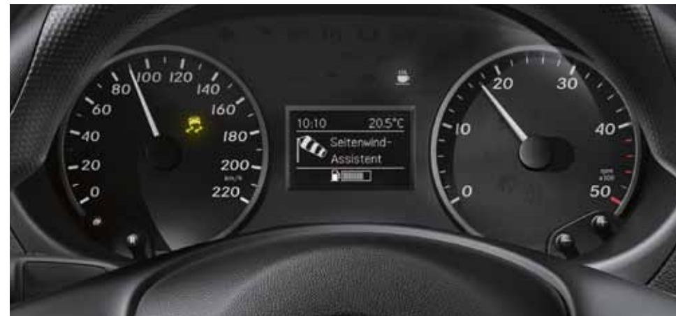
El asistente para viento lateral de serie ayuda a evitar una deriva debida a la acción de viento racheado lateral.
