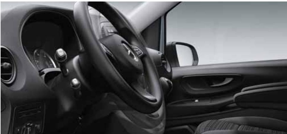
El volante ajustable en altura e inclinación permite a conductores de diferentes estaturas asumir una postura individual y ergonómica sobre el asiento.
