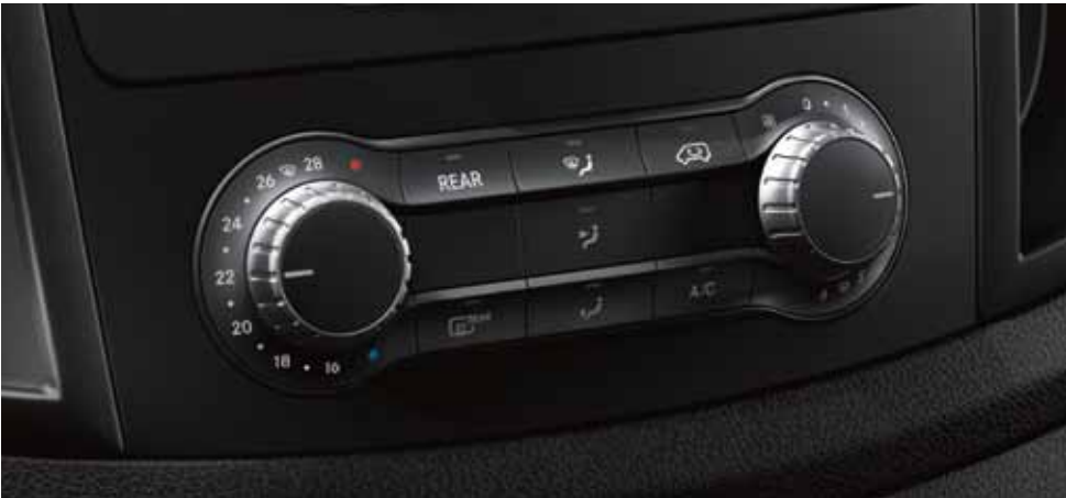
TEMPMATIC regula automáticamente la temperatura deseada para el conductor y el acompañante.
