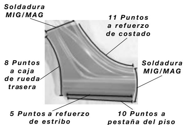
Figura 44- Unión del estribo
