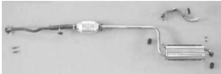
Figura 74- Sistema de escape
