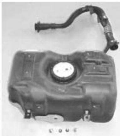
Figura 75- Depósito de combustible
