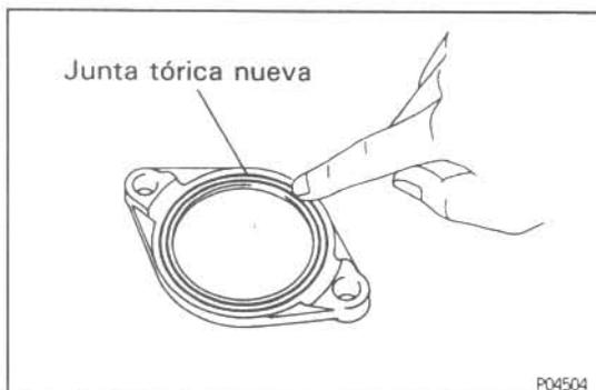
**5. INSTALE LA CUBIERTA N.º 1 DEL BLOQUE DE CILINDROS**
