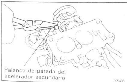
Palanca de parada del acelerador secundario
