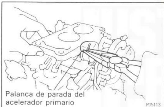
Palanca de parada del acelerador primario
