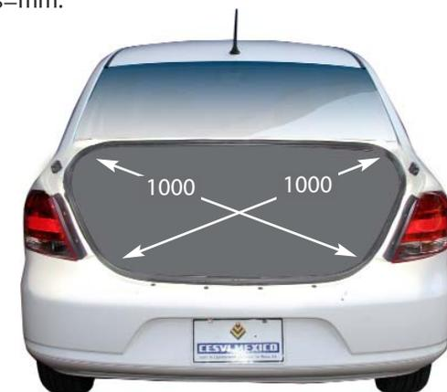
Medidas con juntas y molduras desmontadas
