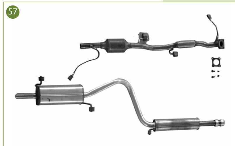
Para desmontar la parte trasera del escape es necesario desmontar el eje trasero.
