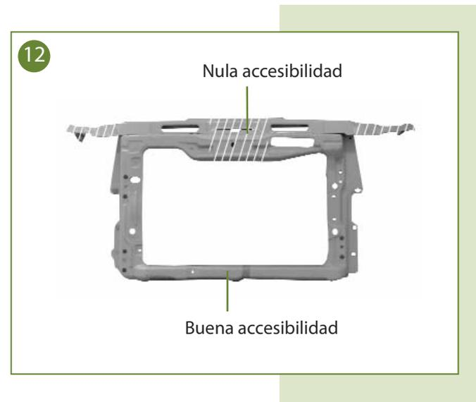
Si se opta por la reparación de esta pieza se deben desmontar únicamente los accesorios necesarios, en función de la magnitud y localización del daño.
