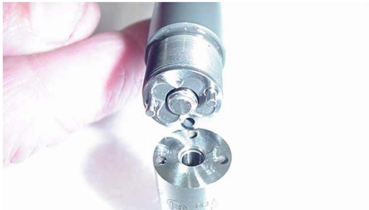
No desmantelar la boquilla del inyector y eje de agujas
