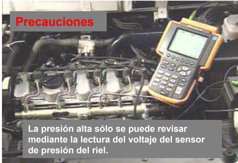
La presión alta sólo se puede revisar mediante la lectura del voltaje del sensor de la presión del riel.
