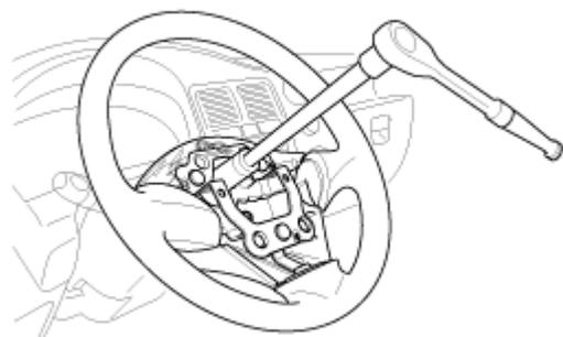
4. Alinee el eje de la dirección con la rueda ya continuación retire el volante (A) con la herramienta especial (09561-11002).
