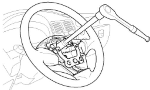
4. Retire el volante (A) con la herramienta especial (09561-11002).
