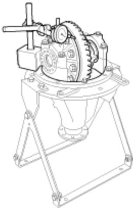
segundo. Si se encuentra fuera del límite, compruebe no hay cuerpos extraños entre el engranaje impulsor y la caja del diferencial y que los pernos que fijan el engranaje impulsor no hay sueltos.
