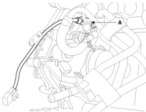
5. Desmonte el sensor de temperatura del refrigerador del motor (A).
