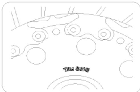
3. Monte el disco del embrague y la cubierta con una herramienta especial (A: 09411-1P000).
