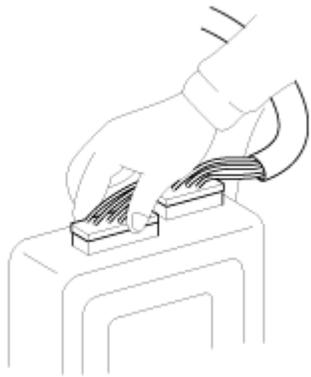
56. Para desconectar un conector, neumático del conector y no de los cables.
