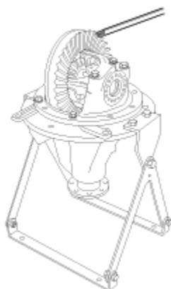
segundo. Inserte una varilla de bronce entre el portadiferencial y la caja del diferencial y luego la cuerda a mano (una vez en dirección normal y otro en dirección inversa) Nm se aplique al piñón impulsor.
