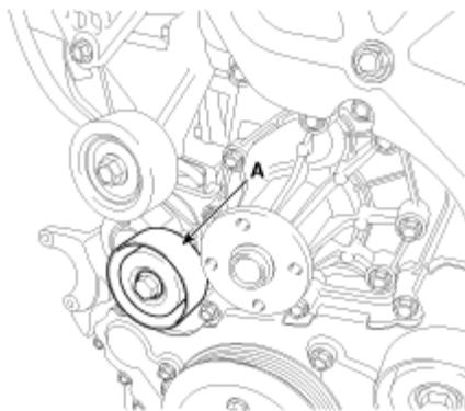
5. Desmonte la bomba de vacío (A) con la junta (B) del bloque de cilindro.
