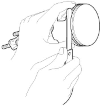
18. Coloque un segmento de pistón en el diámetro de cilindro y colocarlo presionándolo con el pistón.
