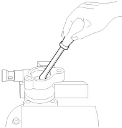
9. Retire el conector (24 milímetros) del cuerpo de la bomba de aceite y extraiga la válvula de presión y el muelle de control de presión.
