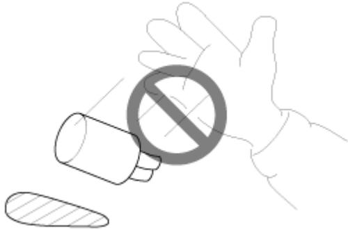
54. Los componentes electrónicos utilizados en el ordenador, los relés, etc., son muy sensibles al calor. Si cumplen los trabajos que hacen que la temperatura supere los 80 ° C (176 ° F) se retiraron antes de los componentes electrónicos.
