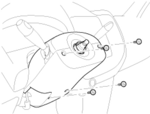
6. Retire el interruptor del limpiaparabrisa y de la iluminación del soporte, después de empujar la sujeción con un destornillador de cabeza plana.
