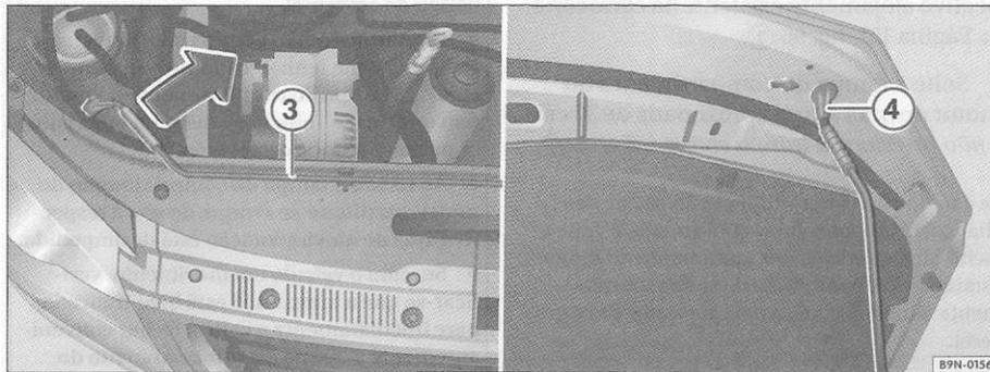
Fig. 96 Figura da esquerda: fixação da haste de sustentação do tampa no compartimento do motor. Figura da direita: tampa levantada
