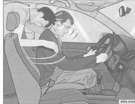
Fig. 8 O passageiro do banco traseiro que não colocou o cinto de segurança é projetado para a frente, para cima dos passageiros dos bancos dianteiros
