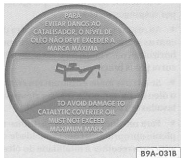
Fig. 99 No compartimento do motor: tampa do bocal de abastecimento de óleo do motor
