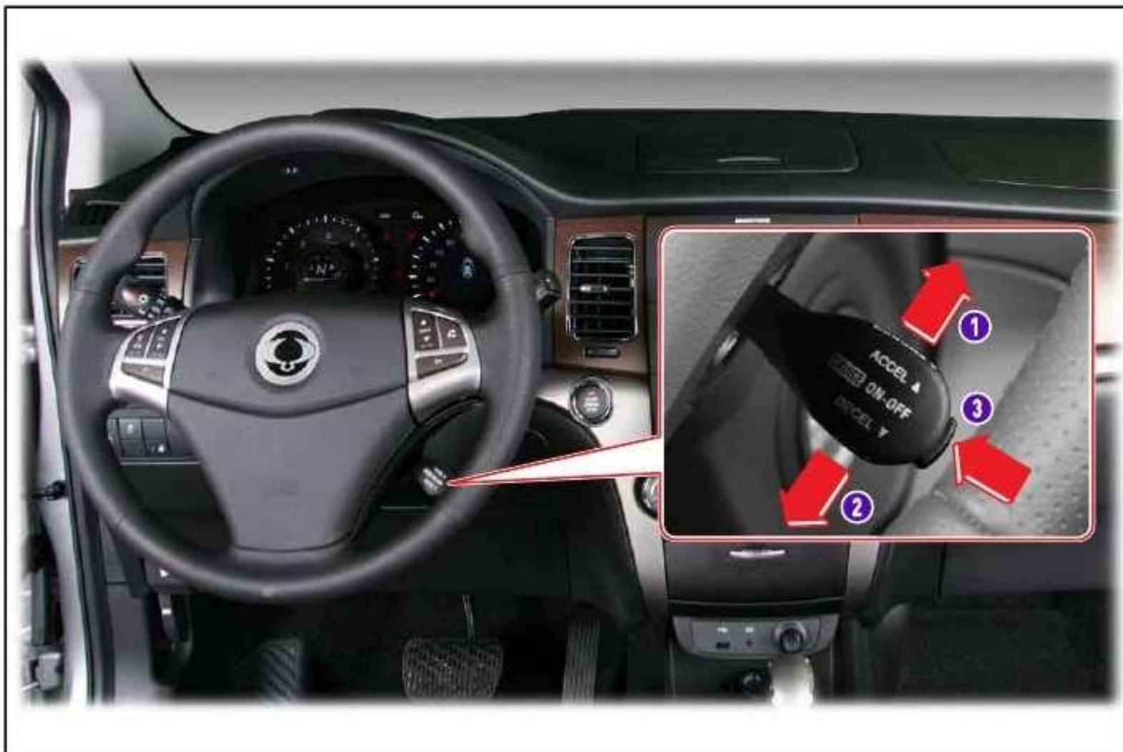
1. Para hacer funcionar el control de crucero, acelerar a la velocidad deseada, que debe ser más del 38 km / h (24 mph) y menos de 150 km / h (90 mph).
