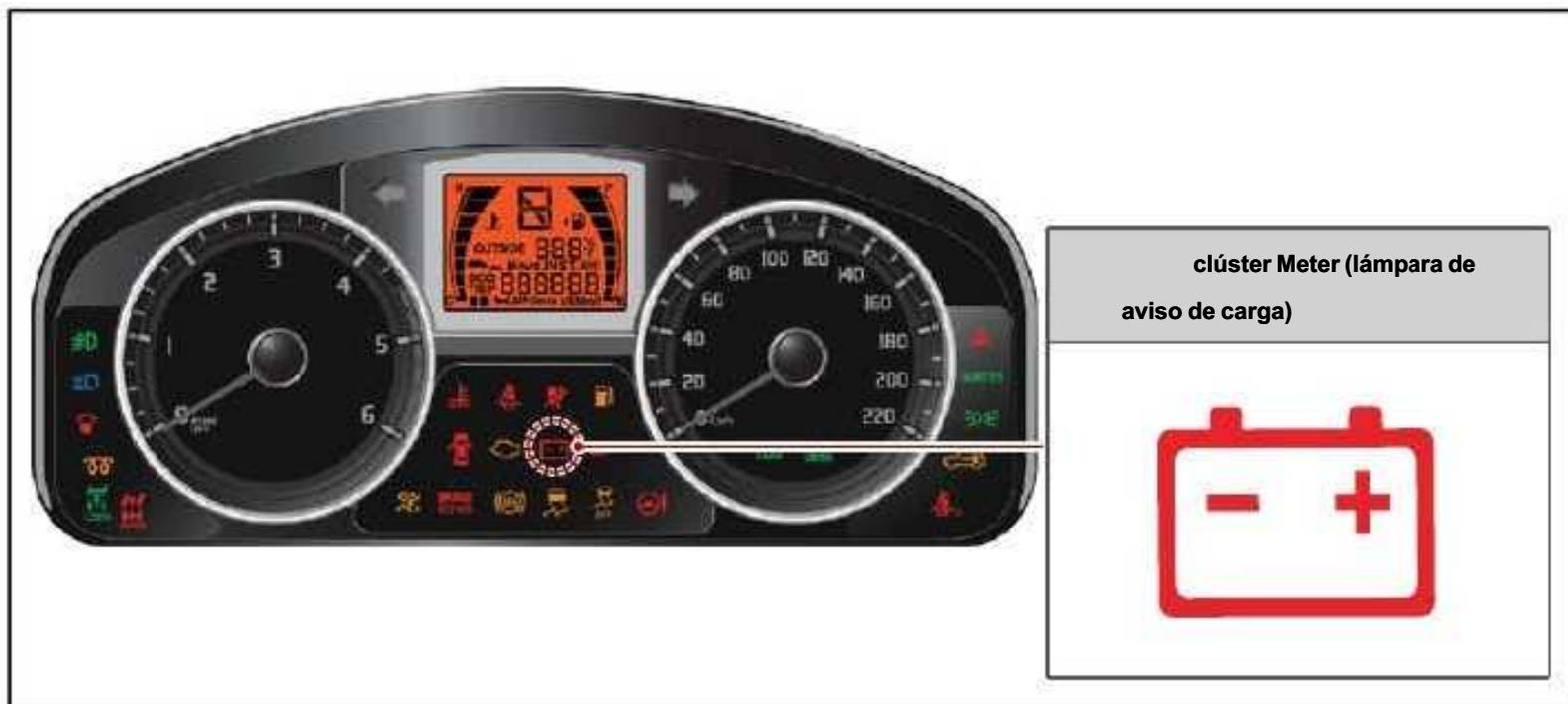
El clúster metros recibe la luz de aviso de carga sobre la señal de ECU a través de la línea CAN.
