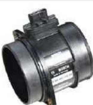
Se utiliza como un valor de mapa principal para controlar la EGR. La temperatura del refrigerante, rpm del motor, carga del motor, la temperatura del aire de admisión (HFM: disminuyó a 60 ° C o más), la presión atmosférica (Sensor de presión atmosférica: compensación de altitud) se utilizan como valores de mapa auxiliares.
