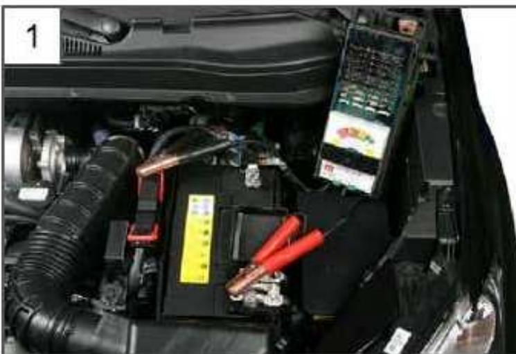
1. Conectar una pinza de medición a “+” terminal de la batería en primer lugar, a continuación, conectar el otra al terminal “-”. (Desconectar el abrazaderas en el orden inverso).
