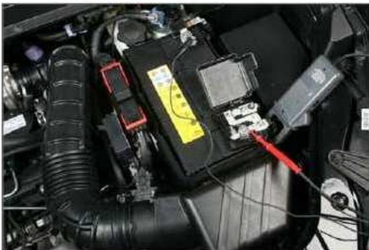
1. Configurar el amperímetro y un voltímetro como se muestra en la figura.
