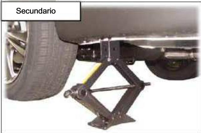
puntos de acceso a Jack y configuración (parte trasera)
