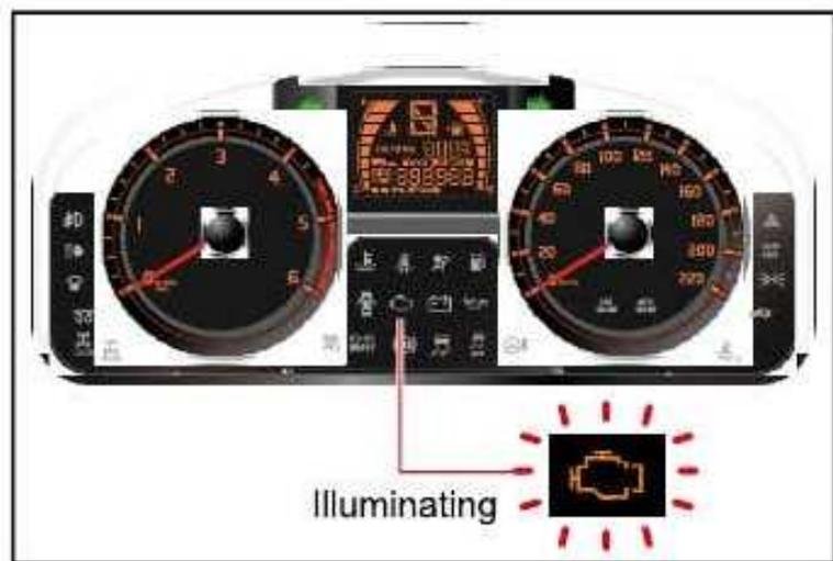
1. Si el vehículo es conducido a una velocidad de 5 a 10 km / h durante un período prolongado de tiempo, el hollín acumulado en el CDPF no puede ser quemado como la CDPF no puede alcanzar la temperatura de regeneración. Entonces, una cantidad excesiva de hollín puede ser acumulado en el CDPF. Este caso es mucho peor que la simple sobrecarga del CDPF. Para informar esto al conductor, la luz de aviso del motor se
