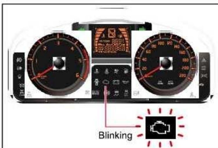
1. Si el CDPF no puede alcanzar la temperatura de regeneración debido a la baja velocidad de conducción o de otra causa, durante el proceso de regeneración, el hollín se acumula continuamente en el CDPF. Cuando esta condición continúa y la CDPF está sobrecargado por el hollín, la lámpara de aviso del motor parpadea para informar de esta situación al conductor.
