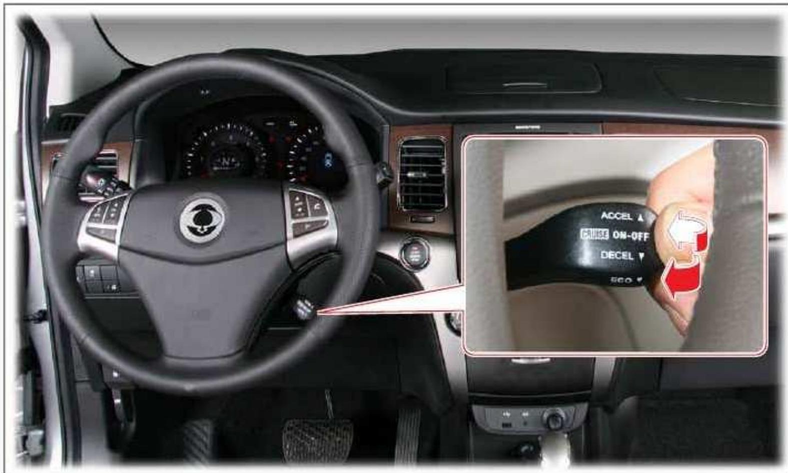
El sistema de control de cruceo ECO tiene casi las mismas funciones con el sistema de control de cruceo automático. Es un sistema de control automático de la velocidad que mantiene una velocidad de marcha deseada sin utilizar el pedal del acelerador.
