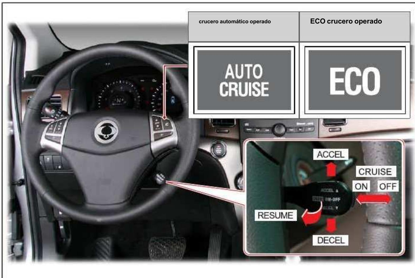
El control de crucero es un sistema de control automático de la velocidad que mantiene una velocidad de marcha deseada sin utilizar el pedal del acelerador.
