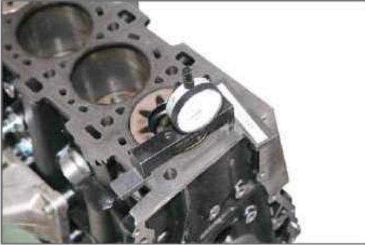
Colocar el pistón en el PMS y medir el saliente del pistón desde la superficie de manivela caso de apareamiento.
