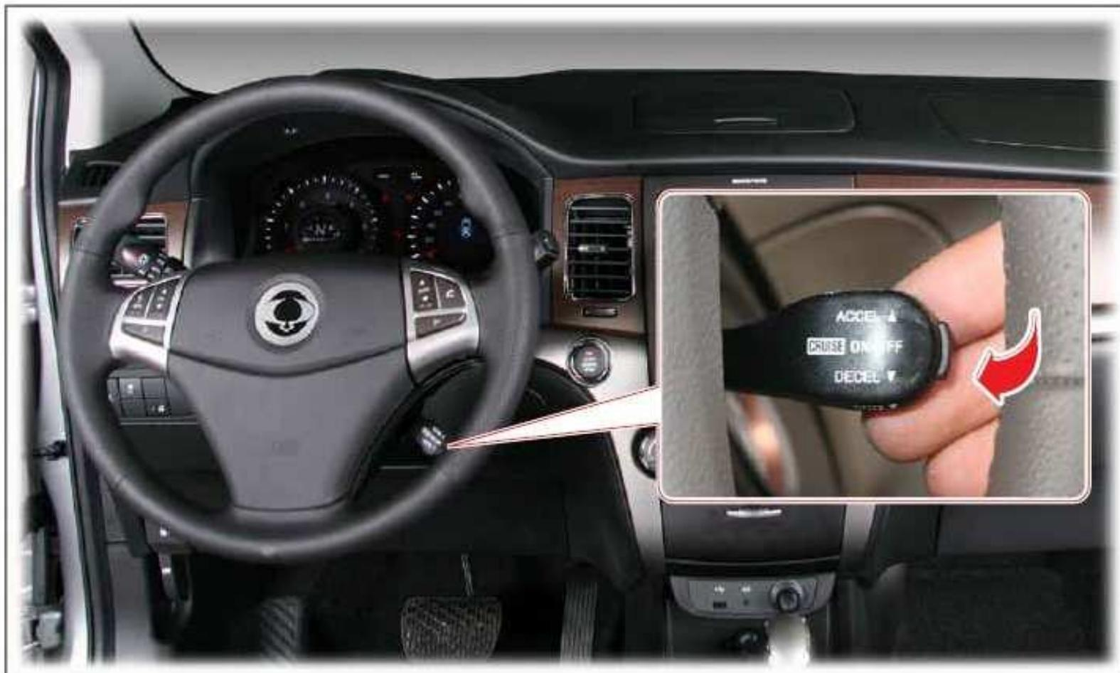
Incluso si el control de cruce se cancela, la velocidad de cruce conjunto anterior se puede recuperar tirando hacia arriba de la palanca de control de velocidad cuando la velocidad actual del vehículo es superior a 38 km / h sin una intervención aceleración. Pero si se apaga el interruptor de encendido, la velocidad establecida memorizada se cancela y no se puede recuperar la velocidad establecida previamente.
