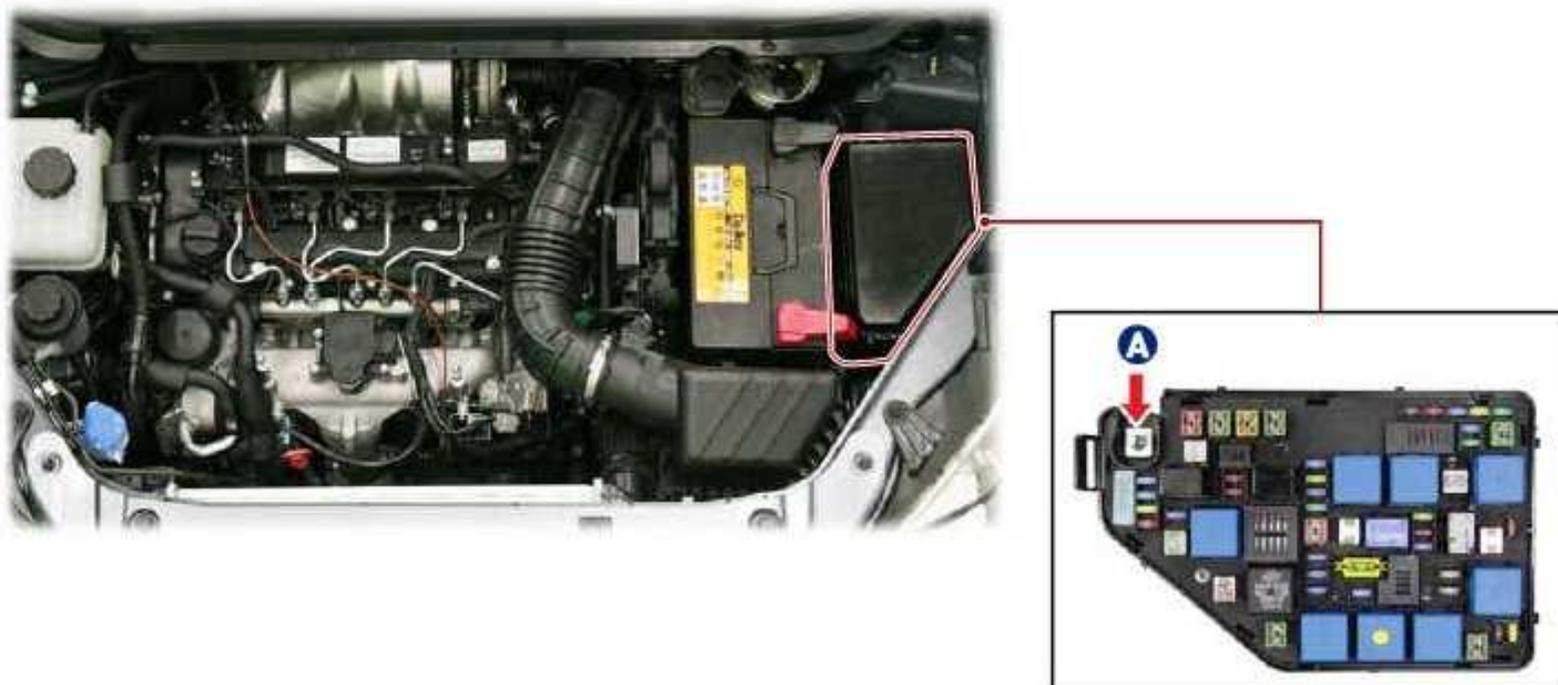
► La capacidad y el nombre de fusibles del compartimiento del motor y el relé
