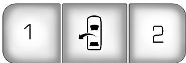
En vehículos con la característica de memoria, los controles de la puerta del conductor se usan para programar y volver a usar la configuración de la memoria para el asiento del conductor y los espejos retrovisores laterales.
