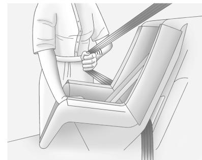
4. Jale el cinturón de hombro completamente fuera del retractor para ajustar el seguro. Cuando el seguro del retractor esté ajustado, el cinturón de hombro se puede apretar pero no se puede sacar del retractor.
