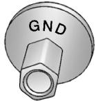
9. Conecte el otro extremo del cable negativo (-) por lo menos a 18" (45 cm) de la batería descargada, pero no cerca de las partes del motor que se mueven.
