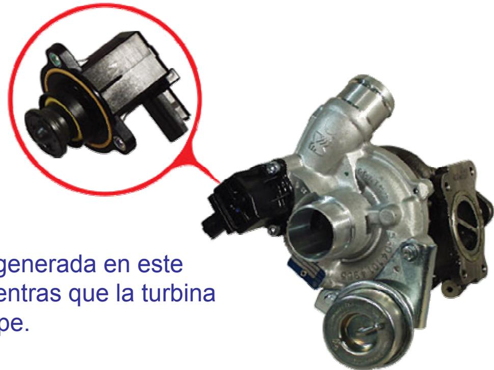
Del lado compresor, la onda de presión generada en este momento retorna hasta el compresor mientras que la turbina aún es accionada por los gases de escape.
