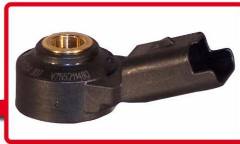
Este sensor no está alimentado, es un generador, suministra una tensión correspondiente a las vibraciones motor
