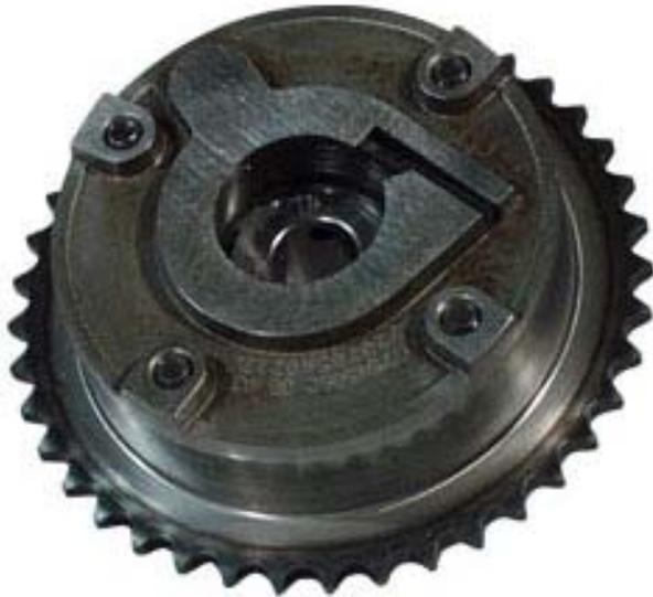
**Función:** adaptar el calado angular de las leyes de apertura de las válvulas de admisión en función de las necesidades
