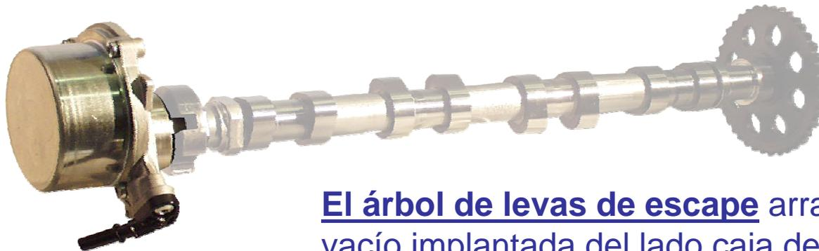
**El árbol de levas de escape** arrastra la bomba de vacío implantada del lado caja de cambios.
