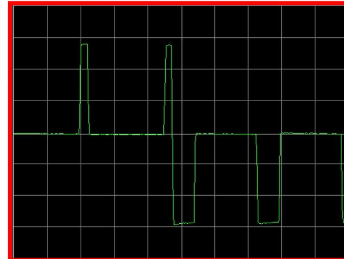
Medida entre los dos cables del motor
