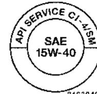
Utilice solamente aceite que responda al Servicio API CI-4. Para el aceite de lubricación empleado en los motores Cummins se especifica un límite de ceniza sulfatada. Los aceites con un alto contenido de cenizas pueden producir depósitos en las válvulas
