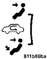
Seleccione los modos de recirculación cuando el aire del exterior contenga humos, malos olores, humedad elevada, o si se desea una refrigeración rápida. Esta característica sólo permite la recirculación de aire interior. El aire circula a través de los respiraderos del tablero solamente o través de los respiraderos del tablero y el suelo, dependiendo del modo seleccionado (tablero o binivel).
