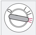
Se activa el motor de arranque. Suelte la llave al arrancar el motor. La llave volverá automáticamente a la posición de conducción.
