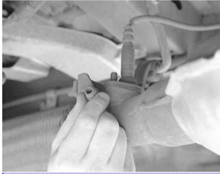
A continuación, tire del sensor fuera del componente de escape
