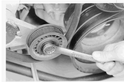
Verificación de la alineación de la correa serpentina en la polea
