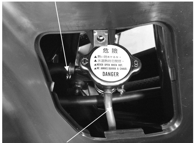
Tubo de ventilación del aire
