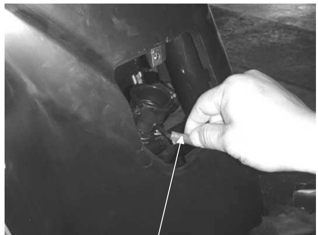
Tubo de ventilación de aire
