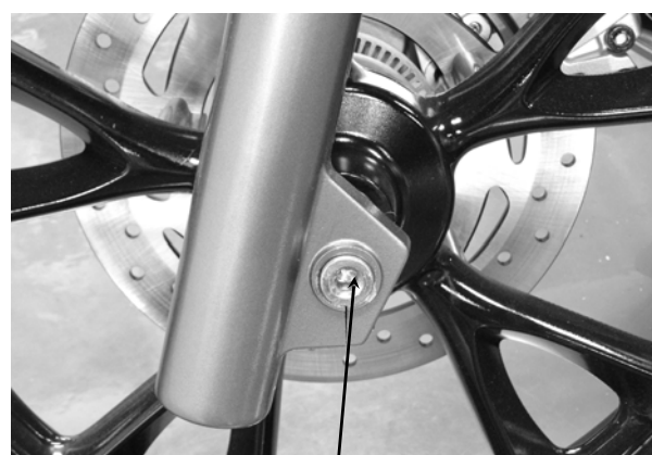
Tuerca del eje delantero
