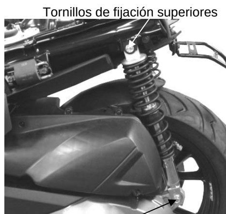
Tornillos de fijación inferiores
