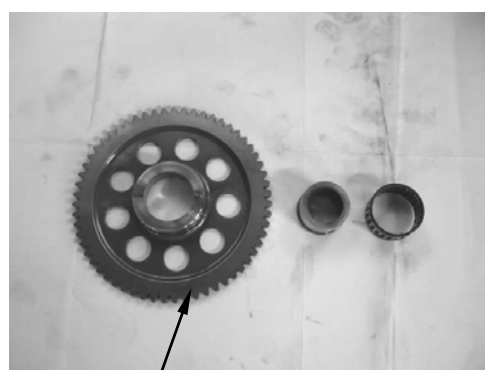
Engranaje secundario de arranque
