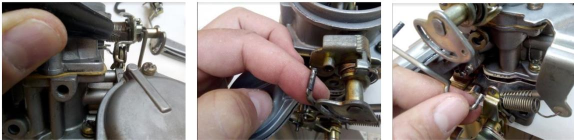
Extracción varilla de acople eje choke a eje de aceleración.
