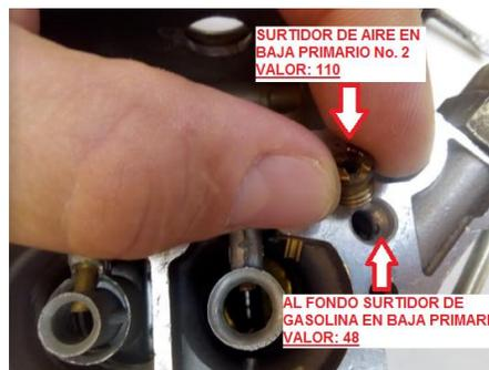
Surtidor de aire en baja primario No.2 y surtidor de gasolina en baja primario
