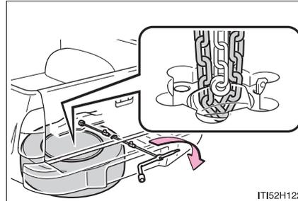
En los vehículos con el candado en la posición tipo A (→P. 458), vuelva a colocar el candado después de fijar el neumático.
