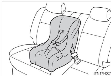
Cinturones de seguridad de tipo 3 puntos (los cinturones con ELR requieren clips inmovilizadores)
