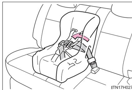
**Instalación del sistema de sujeción para niños con un cinturón de seguridad (cinturón de seguridad de tipo 3 puntos)****■ Asiento para bebés/asiento para niños — Orientado hacia atrás**
