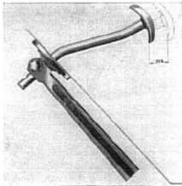
FIG. 18. — AJUSTE DEL PEDAL DEL EMBRAGUE
