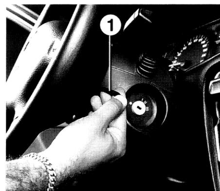
Desmontaje de la unidad de airbag.
