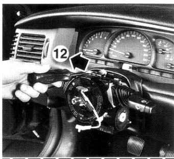
Alineamiento de las marcas del contactor de airbag.
