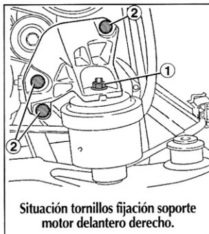
Situación tornillos fijación soporte motor delantero derecho.
