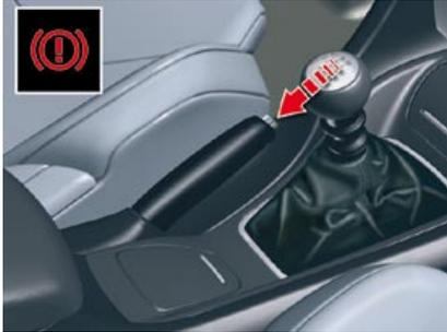
Dispositivo mecánico que permite mantener el vehículo parado.
