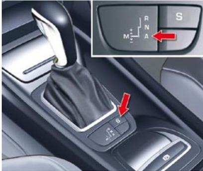
☞ Con la palanca de cambios en posición **A** y el motor en marcha, pulse el botón **S** para activar el programa **SPORT**, que proporciona un estilo de conducción más dinámico.
