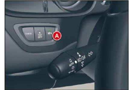
Para seleccionar la función de medición de plaza disponible, pulse el mando **A**. El encendido fijo del testigo indica que se ha seleccionado la función.
