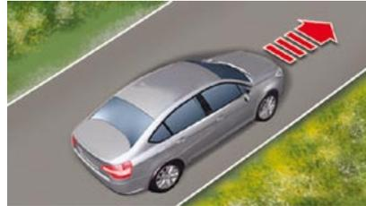
**En pendiente ascendente, con el vehículo parado, éste se mantiene durante un momento al soltar el pedal del freno:**
