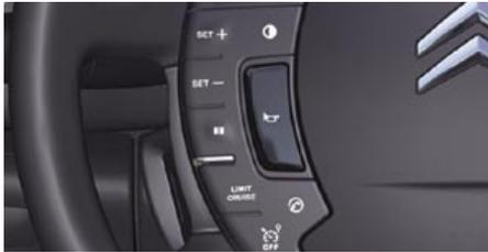
Este sistema permite no superar la velocidad máxima elegida por el conductor.
