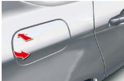
☞ Presione en la parte superior izquierda y tire del borde de la tapa.
