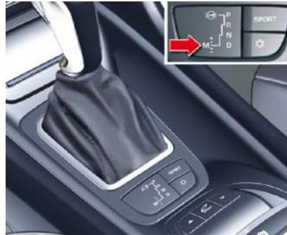
Posición de la palanca de cambios para cambiar manualmente de marcha.
