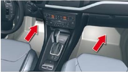
Al abrir alguna puerta, estas luces situadas en la parte delantera alumbran el interior del vehículo.
