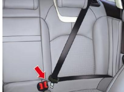
Las plazas traseras están equipadas con tres cinturones, dotados cada uno de ellos con tres puntos de anclaje y un enrollador con limitador de esfuerzo.
