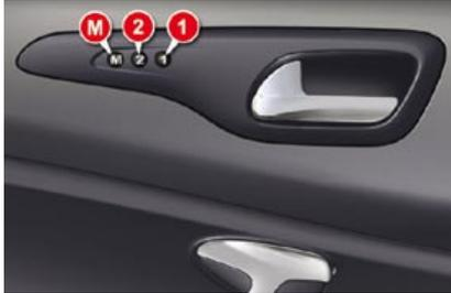
El sistema memoriza los reglajes del asiento del conductor y de la climatización. Le permite guardar hasta dos posiciones mediante las teclas del lateral del asiento del conductor.
