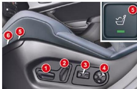
1. Reglaje longitudinal, de la altura y de la inclinación del cojín de asiento.
