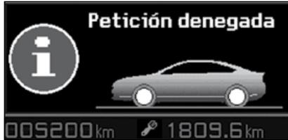
La pantalla del cuadro de a bordo muestra temporalmente un mensaje indicando la imposibilidad del reglaje. El vehículo se queda en una posición autorizada y la pantalla del cuadro de a bordo indica esa posición.
