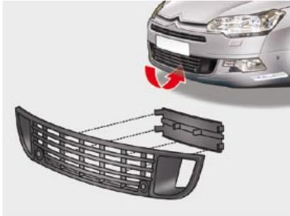
En caso de remolcado del vehículo, es obligatorio retirar el obturador situado en el paragolpes delantero, así como la junta del capó, si el vehículo dispone de ella.
