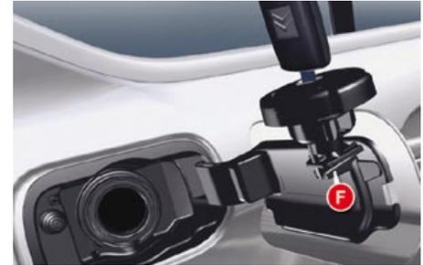
Para abrir la tapa, presione en la parte superior izquierda y tire del borde.
