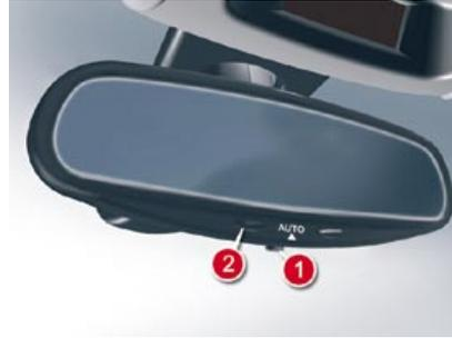
En los vehículos equipados con retrovisores exteriores electrocromos, el sistema dispone de un interruptor encendido/apagado y un testigo asociado.
