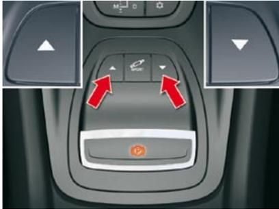
**Los cambios de posición sólo se efectúan con el motor en marcha.**
