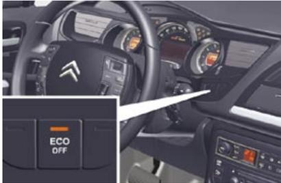
En caso de fallo de funcionamiento del sistema, el testigo del mando "ECO OFF" parpadea y luego se enciende de manera fija.
