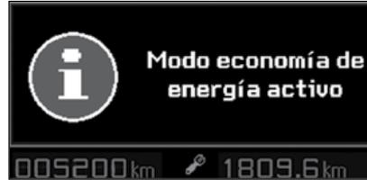
Después de apagar el motor, algunas funciones (autorradio, limpiaparabrisas y limpiacristales, elevalunas, techo corredizo, asientos eléctricos, teléfono, vídeo, iluminación interior, portón motorizado, etc.) sólo reciben alimentación eléctrica durante aproximadamente una hora, con el fin de no agotar la carga de la batería.
