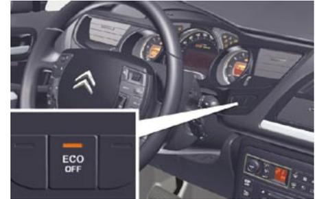
El sistema puede neutralizarse en cualquier momento pulsando el mando "ECO OFF". El testigo de la tecla se encenderá.
