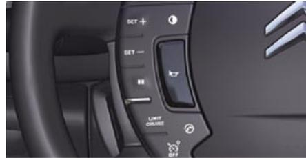
Este sistema permite mantener el vehículo constantemente a la velocidad programada por el conductor.
