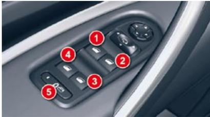
1. Mando del elevalunas eléctrico del conductor.
