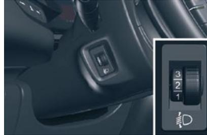
Para no molestar a los demás conductores, debe regularse la altura de los faros con lámparas halógenas, en función de la carga del vehículo.
