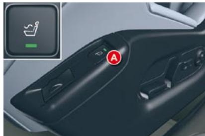
Esta función le proporciona un masaje lumbar al conductor y sólo funciona con el motor en marcha.
