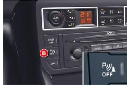
La ayuda al estacionamiento se puede activar/desactivar pulsando el mando **B**. Si la ayuda está desactivada, el testigo del mando **B** está encendido.
