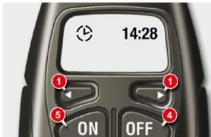
Después de ver la hora pulsando las teclas **1**, pulse en los 10 segundos siguientes las teclas **4** y **5** simultáneamente.
