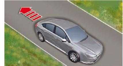
**En pendiente descendente, con el vehículo parado y la marcha atrás introducida, el vehículo se mantiene un momento al soltar el pedal del freno.**
