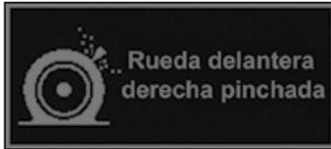
El sistema de detección de subinflado es una ayuda a la conducción que informa al conductor sobre el estado de los neumáticos.
