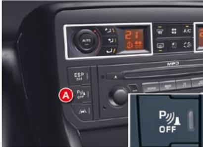
☞ Pulse de nuevo el botón **A**. El testigo se apaga y el sistema se reactiva.
