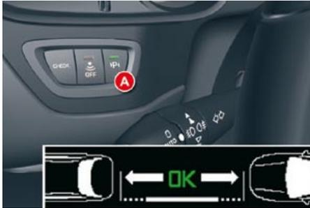
Para seleccionar la función "Medición de plaza disponible", pulse el mando **A** con el indicador de dirección del lado del espacio que quiere medir activado, circulando a velocidad inferior a 20 km/h y a una distancia inferior a 1,5 m de la plaza.
