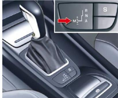
☞ Desplace la palanca hasta la posición **M**.
