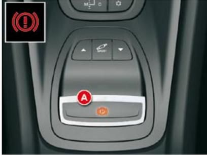
En caso de fallo del sistema de frenos principal o en situaciones excepcionales (por ejemplo, malestar del conductor, acompañando a un conductor novel...), tire del mando **A**, sin soltarlo hasta que se detenga el vehículo.
