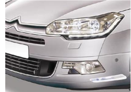
Para no molestar a los demás usuarios de la vía, este sistema corrige, automáticamente y con el motor parado, la altura del haz de luz de las lámparas de xenón, en función de la carga del vehículo.
