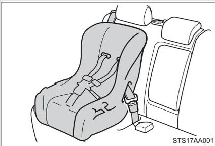
Los cinturones de seguridad equipados con un mecanismo de bloqueo para sujeción de niños (cinturones ALR/ELR excepto cinturón de seguridad del conductor) (→P. 43)
