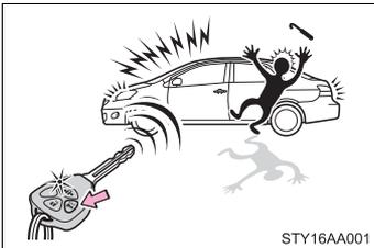
Cuando el **HOLD** (ícono de un dedo presionando) se oprime por más de 1 segundo, una alarma sonará por unos 60 segundos y las luces del vehículo destellarán para disuadir a cualquier persona que trate de ingresar por la fuerza o dañar al vehículo.
