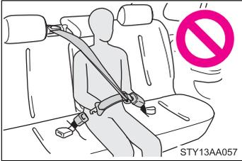
No utilice el cinturón del asiento trasero central con ninguna de las hebillas sueltas. El abrochar solamente una de las hebillas puede dar como resultado la muerte o lesiones graves en caso de un frenaje repentino o una colisión.
