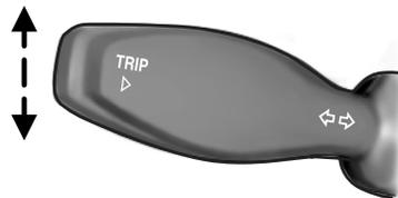
Empuje la palanca hacia arriba o hacia abajo para utilizar los intermitentes.
