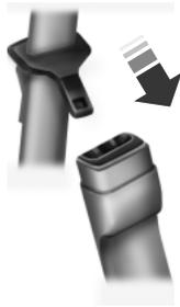
4. Inserte la lengüeta del cinturón en la hebilla adecuada (la hebilla más cercana a la dirección desde la cual proviene la lengüeta) para esa posición del asiento hasta que escuche un chasquido y sienta que se ha enganchado. Jale la lengüeta para asegurarse de que esté firmemente enganchada.
