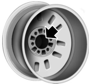
**Nota:** inspeccione el orificio de guía de la rueda y la superficie de montaje antes de la instalación. Elimine cualquier corrosión visible o partículas sueltas.
