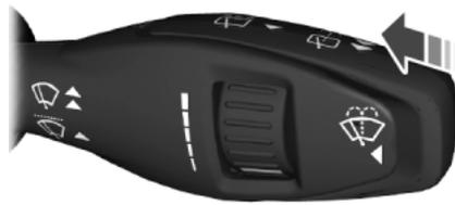
El lavador atomizará mientras la palanca esté presionada. Después que usted libere la palanca, los limpiaparabrisas operarán por un tiempo corto.
