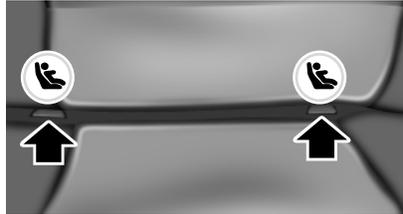
Los anclajes LATCH se localizan en la sección posterior del asiento trasero, entre el cojín y el respaldo, debajo de los símbolos que se muestran. Siga las instrucciones del fabricante del asiento para niños para instalar correctamente los asientos para niños con conexiones LATCH.
