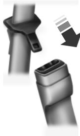
1. Inserte la lengüeta del cinturón en la hebilla correcta (la hebilla más cercana a la dirección de la cual proviene la lengüeta) hasta que escuche un chasquido y sienta que se ha enganchado. Asegúrese de ajustar firmemente la lengüeta en la hebilla.
