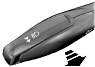
Para activar, jale por completo la palanca más allá del retén. Para desactivar, otra vez jale por completo la palanca.
