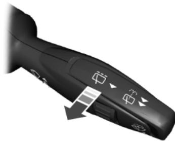
Jale la palanca hacia usted para activar la limpieza intermitente.
