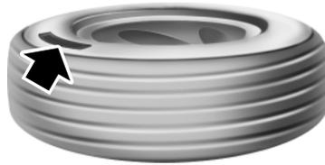
Los grados de calidad de las llantas se aplican a llantas neumáticas nuevas para automóviles de pasajeros. Los grados de calidad se pueden encontrar, donde sea aplicable, en el costado de la llanta entre el reborde de la banda de rodadura y el ancho máximo de sección. Por ejemplo:
