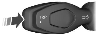
Presione el extremo de la palanca, situada del lado izquierdo del volante de la dirección, para desplazarse por las pantallas de la computadora de viaje.
