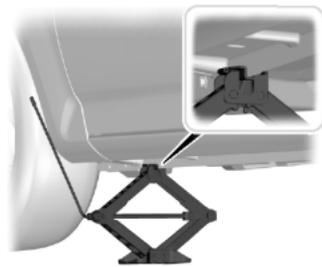
7. Coloque el gato en las muescas del estribo, junto a la llanta que esté cambiando. Gire la manivela del gato hacia la derecha hasta que la llanta se haya levantado del suelo.
