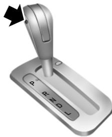
Al presionar el interruptor de control de la transmisión (TCS) que está en el lado de la palanca de cambio de velocidades, se activa la asistencia en pendientes y se cancela la sobremarcha.
