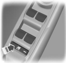
Presione el control para bloquear o desbloquear los controles de las ventanas traseras.
