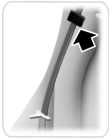
3. Guarde el cinturón de seguridad en la abrazadera de almacenamiento del cinturón. Esto evitará que el cinturón de seguridad se atore en el seguro del asiento.
