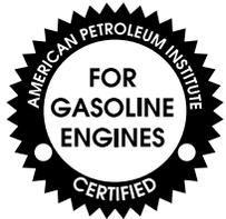
Utilice exclusivamente aceites para motores de gasolina certificados por American Petroleum Institute (API). Un aceite con esta marca registrada cumple con las normas actuales de protección del sistema de emisión de gases y motor, y con los requerimientos de ahorro de combustible del International Lubricant Standardization and Approval Committee (ILSAC), conformado por fabricantes de automóviles de los
