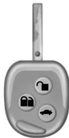
Su vehículo podría estar equipado con dos transmisores integrados a la llave. La hoja de la llave se utiliza para arrancar el vehículo y desbloquear o bloquear la puerta del conductor desde fuera del vehículo. La parte del transmisor funciona como el control remoto.
