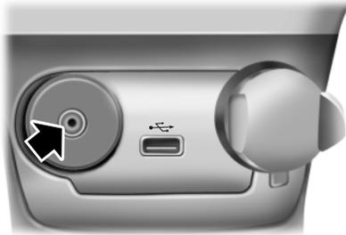
El enchufe de entrada auxiliar (AIJ) le permite conectar y reproducir música desde su reproductor de música portátil mediante los altavoces del vehículo. Puede usar cualquier reproductor de música portátil diseñado para uso con auriculares. Su cable de extensión de audio debe tener conectores macho de 3.5 mm (1/8 pulg) en ambos extremos.
