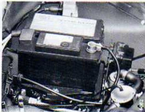
**Atención:** mantenga la batería siempre en la vertical y no la incline más de 45°, a fin de evitar fugas de electrolito por los respiros.
