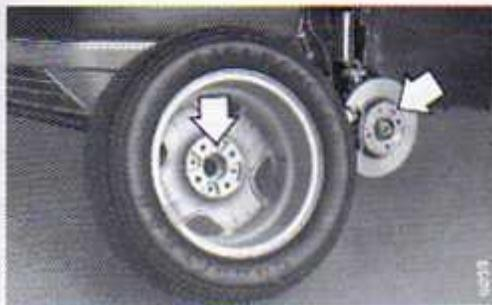
**Atención:** la rueda de repuesto de los vehículos equipados con ruedas de aleación liviana (originales de fábrica), solamente puede ser utilizada en estos y viene marcada con una etiqueta adhesiva.
