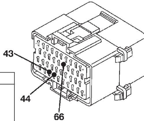
CONECTOR DEL SENSOR DE VELOCIDAD DEL VEHICULO
