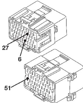
CONECTORES DEL MODULO DE CONTROL DEL MECANISMO DE TRANSMISION
