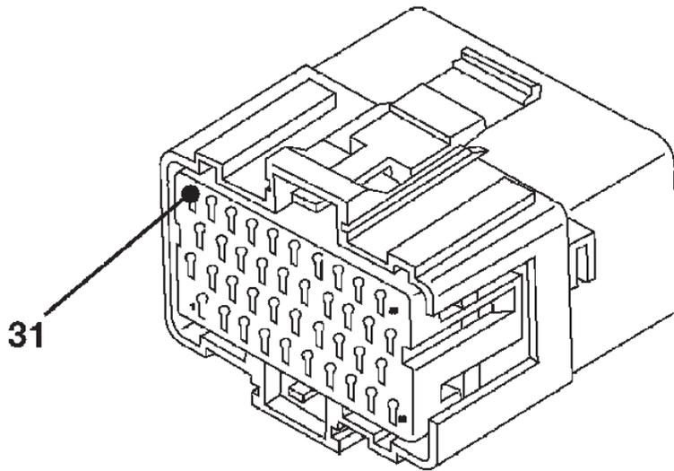
CONECTOR DEL MODULO DE CONTROL DEL MECANISMO DE TRANSMISION
