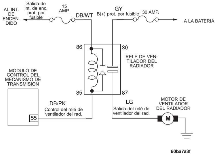
CONECTOR DEL RELE DE VENTILADOR DEL RADIADOR
