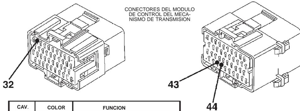
CONECTORES DEL MODULO DE CONTROL DEL MECANISMO DE TRANSMISION
