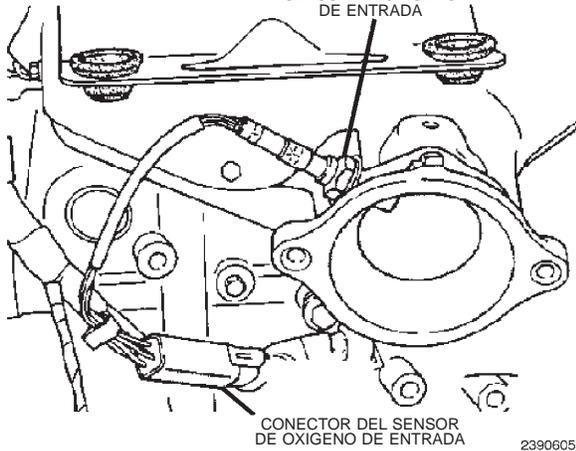
CONECTOR DEL SENSOR DE OXIGENO DE ENTRADA
