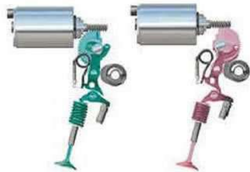
Funcionamiento con alzada de válvula variable mediante una regulación electrónica continua
