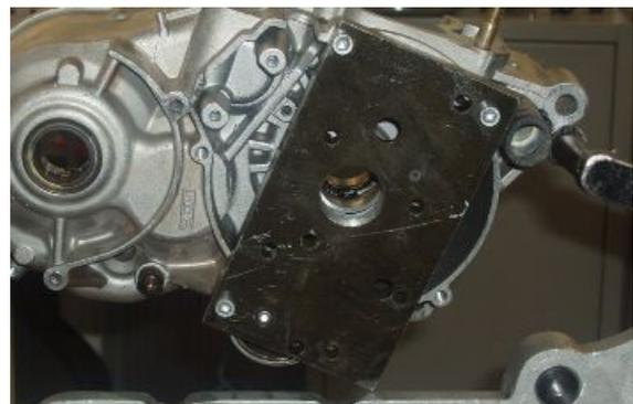
operación de colocación, mantener la biela en la dirección del eje del cilindro.
