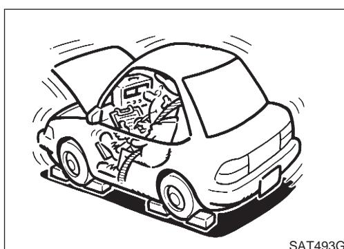
5. Poner en marcha el motor y medir la presión de línea a ralentí y a la velocidad de calado.
