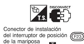
Conecotor de instalación del interruptor de posición de la mariposa (F23)
