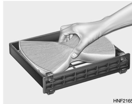
5. Retire el filtro del aire del climatizador levantándolo.
