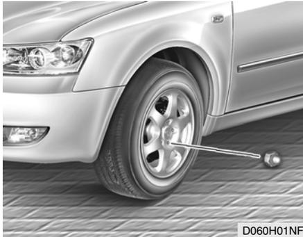
Para instalar los tapacubos, sujételas en la rueda y luego ponga las tuercas en los espárragos y apriételes con los dedos. Las tuercas deben instalarse con el menor diámetro hacia el interior. Mueva la rueda para asegurarse que está debidamente asentada, luego reapriete las tuercas con los dedos de nuevo.
