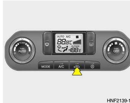
Se utiliza para seleccionar aire fresco exterior o hacer circular el aire interior, evitando la entrada de gases de escape.
