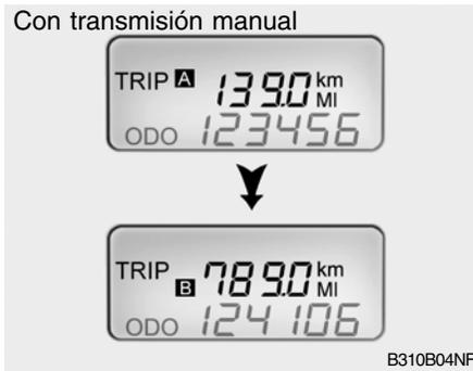
Para conmutar de TRIP A a TRIP B, pulse el interruptor TRIP.
