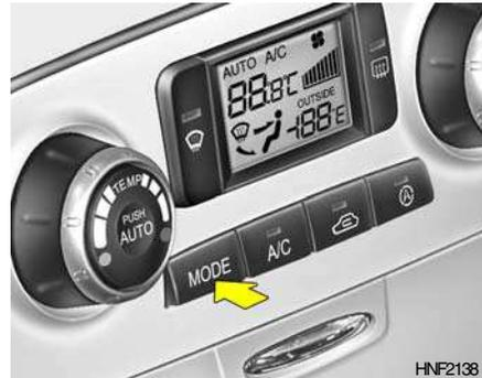
Es utilizado para dirigir la dirección del flujo de aire. El aire puede ser dirigido al suelo, a las salidas del tablero de instrumentos, o al parabrisas. Para representarlo, se utilizan cuatro símbolos de posición a la cara, bivel, suelo y suelo/desempañado.
