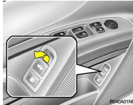
El maletero se abre tirando de la palanca de apertura del maletero y levantando la puerta del maletero.
