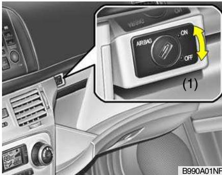
Se puede desactivar el airbag frontal del copiloto mediante el interruptor de activación/desactivación del airbag frontal del copiloto (1) si se instala un sistema de retención para niños o si el asiento del copiloto no está ocupado. Para garantizar la seguridad de su hijo, debe desactivarse el airbag frontal del copiloto, en casos excepcionales en los que sea necesario instalar un asiento para niños de espaldas a la dirección de la marcha en asiento del copiloto.
