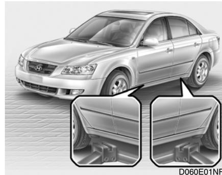
La base del gato debe apoyarse en un lugar firme y nivelado. Instálndola como se enseña en la figura.
