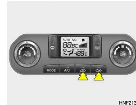
Este dispositivo es utilizado para elegir aire fresco del exterior o recirculación de aire del interior.
