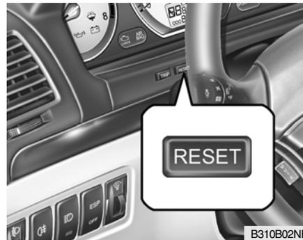
Pulsando el botón RESET durante 1 segundo, el odómetro de viaje se fija a 0.
