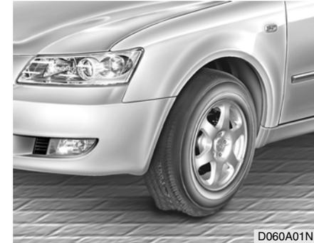
El procedimiento que se describe en las próximas páginas, puede utilizarse tanto como para rodar las ruedas como para cambiarlas, cuando haya una pinchada. Cuando se prepare para cambiar una rueda pinchada, compruebe que la palanca está en "P" (A/T) o marcha atrás (mecánica) y el freno de mano puesto, entonces:
