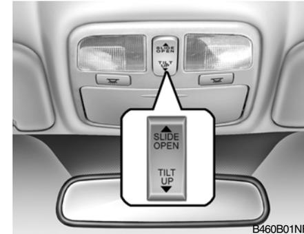
Si su vehículo está equipado con esta opción, puede deslizar o inclinar el techo solar con los botones de mando correspondientes, situados en la consola que está sobre el parabrisas. Solamente se puede abrir, cerrar o inclinar el techo solar cuando el contacto está en la posición "ON".
