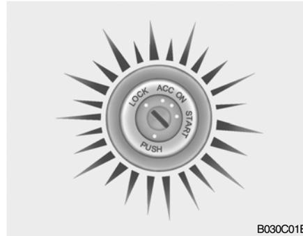
Cuando la puerta del coche se abre, el bombín de contacto se ilumina para su comodidad. La luz permanecerá encendida durante 10 segundos, después de que la puerta ha sido abierta o se ha accionado la llave de contacto.
