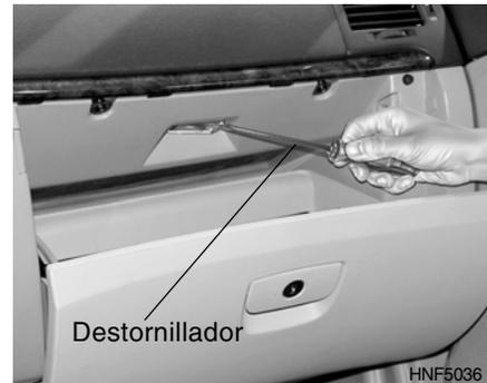
2. Extraiga la tapa de la luz de la guantera con un destornillador plano.
