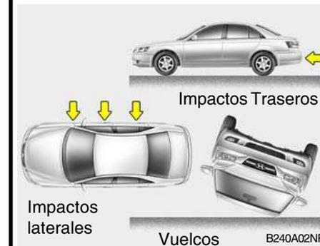
o Los airbags delanteros no están pensados para desplegarse en impactos laterales, traseros o vuelcos. Además, los airbags no se desplegarán en choques frontales por debajo de la velocidad umbral de despliegue.
