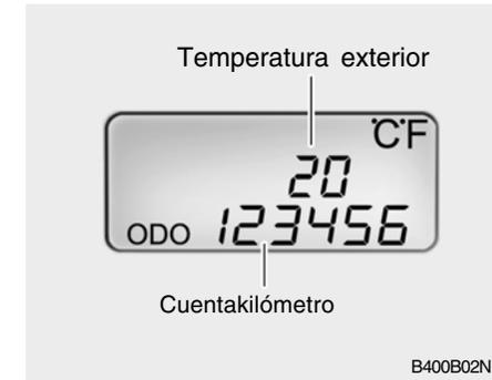
Este modo indica la temperatura exterior entre -40°C (-40°F) y 80°C (176°F).
