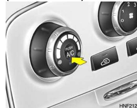
El aire acondicionado será conectado o desactivado mediante el pulsador de control.
