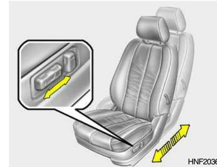
Tire la palanca de control hacia adelante o hacia atrás, para mover el asiento a la posición deseada. Suelte el tirador y el asiento quedará asegurado.
