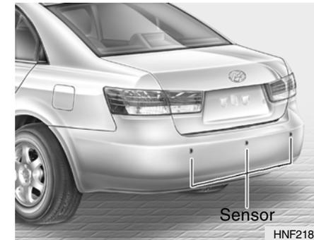
El sistema de ayuda de estacionamiento trasero asiste al conductor en el movimiento de marcha atrás del vehículo emitiendo una señal acústica si se detecta algún objeto a una distancia de 47 pulgadas (120 cm) detrás del vehículo.
