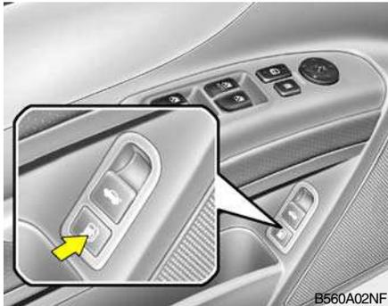
La tapa para el llenado de combustible se abre desde el interior del vehículo, pulsando el mando para ello situado en la puerta del conductor.
