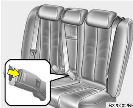
Cuando se desee soltar el cinturón de seguridad, presionar el pulsador situado en la hebilla de bloqueo.
