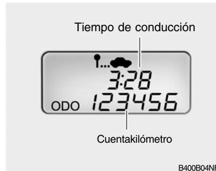
Tras reajustarlo a cero indica el tiempo total desde la puesta en marcha del vehículo hasta la desconexión de la llave de encendido. Se reajusta a cero (0:00) pulsando el interruptor RESET de la computadora de viaje.
