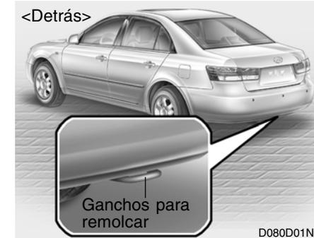
En caso de tener que remolcar el vehículo por producirse una emergencia y si no está disponible ninguna grúa comercial, acople un cable de remolque, una cadena o una
