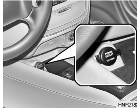
Esta toma suministra una corriente eléctrica de 12V para el uso de accesorios o equipamiento eléctrico sólo cuando la llave de contacto se encuentra en la posición "ON" o en la posición "ACC".
