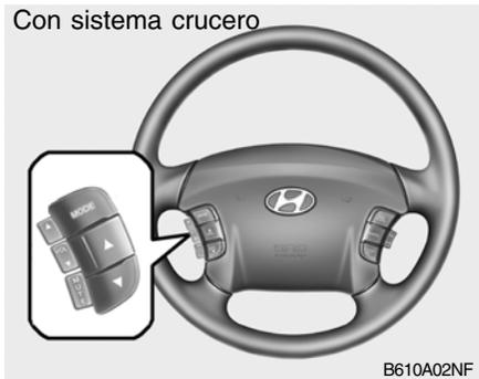
El mando a distancia del sistema de audio instalado en el volante ha sido diseñado para aumentar la seguridad durante la conducción.
