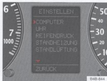
Seleccione ahora los ajustes que desee efectuar y pulse otra vez el botón giratorio / pulsador. Aparecerá la función de ajuste. El ajuste y la introducción de valores se efectúan igualmente girando / pulsando el botón giratorio / pulsador.
