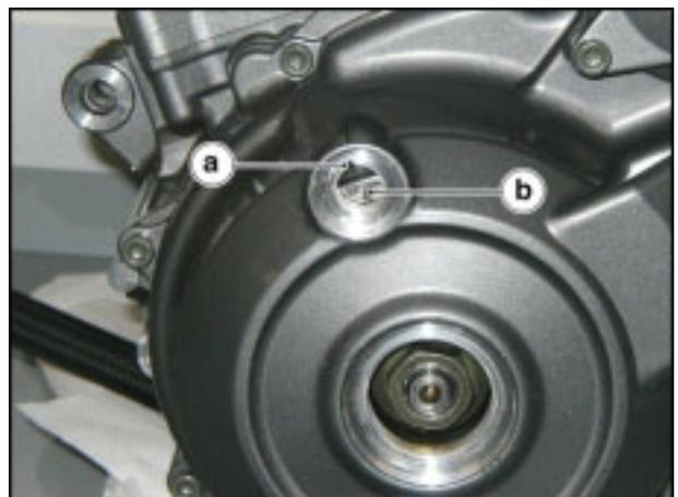
**IMPORTANTE** Para colocar el pistón en el PMS en la fase de compresión, alinear la referencia "1" en la rueda dentada del árbol de levas, con la referencia fija de la culata.
