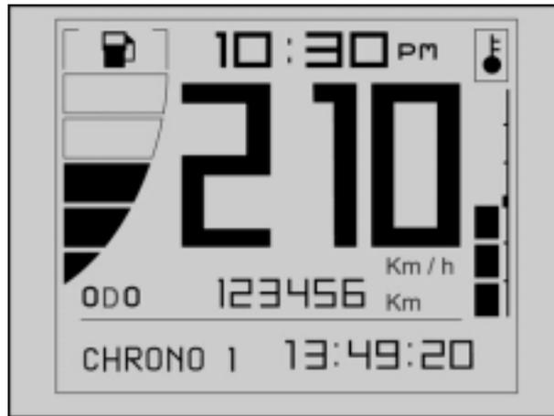
Cada vez que se presiona nuevamente el selector MODE en la posición central luego de los 10 segundos del inicio, la medición se interrumpe, se memoriza y comienza una nueva medición. La serie de mediciones se interrumpe cada vez que se presiona prolongadamente el selector MODE en la posición central.
